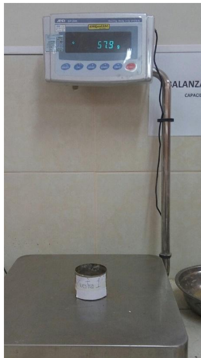
Imagen N°12: Finalmente pesamos la muestra Numero 1, que contiene 57.9 gramos de sedimento.
