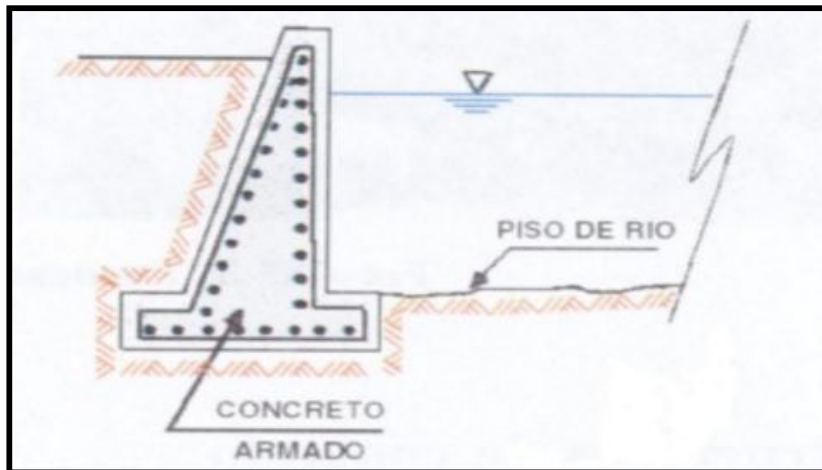
Figura 18. Muros de concreto armado
