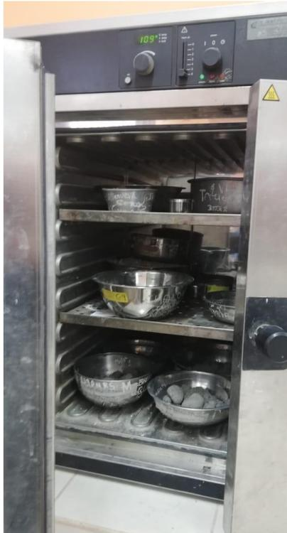
**Figura 46: Muestras por ser extraídas del horno luego de 24 horas.**
