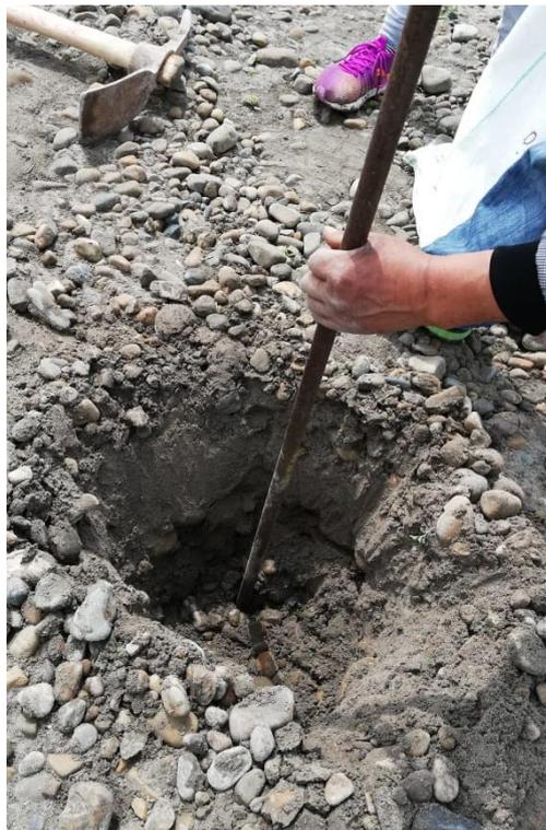
**Figura 38: Extracción de muestra de suelo de una de las calicatas.**
