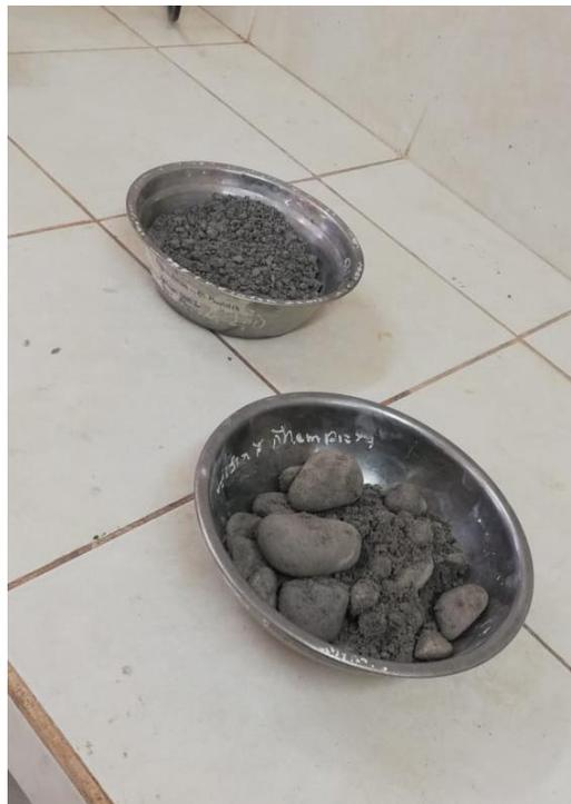
**Figura 47: Muestras sin humedad luego de ser retiradas del horno**
