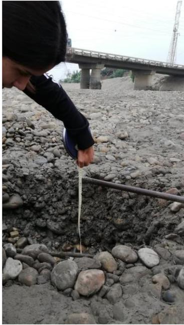
**Figura 39: Medición de altura de fondo de una de las calicatas**
