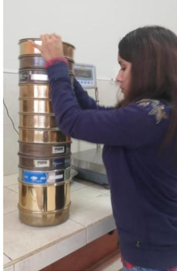
**Figura 20: Proceso de tamizado de muestras.**
