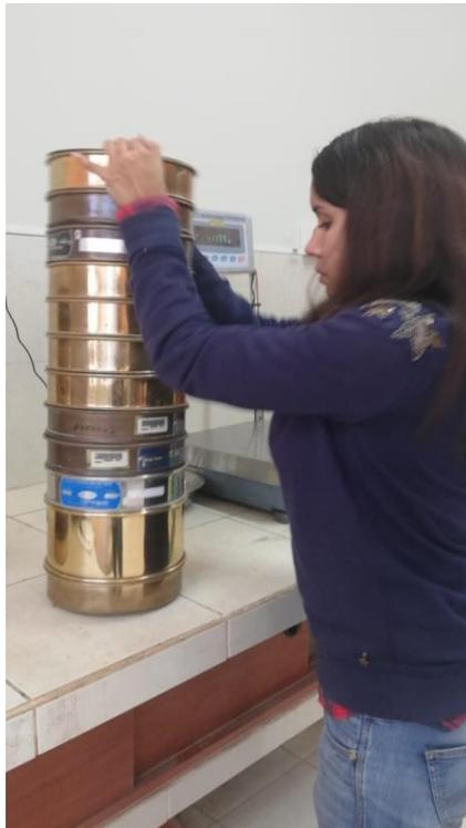
**Figura 49: Muestra siendo agitada para que pase por todos los tamices.**
