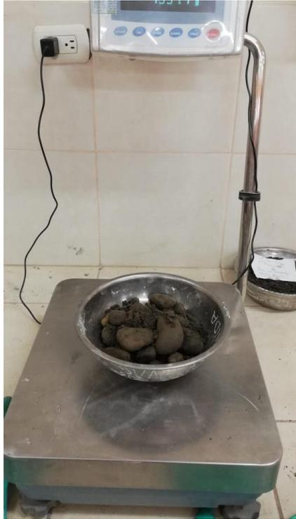
**Figura 44: Muestra puesta en la balanza para su pesaje antes de ser puesta en el horno.**
