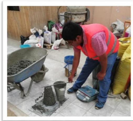
Ilustración 6: Ensayo de asentamiento, prueba de slump.
