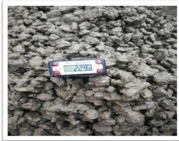
Ilustración 4: temperatura del concreto permeable
