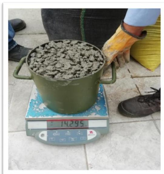
Ilustración 5: Peso unitario del concreto permeable
