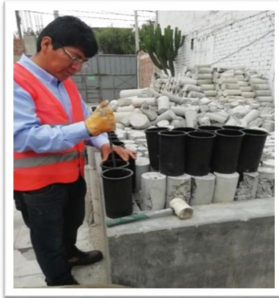
Ilustración 2: Cilindros para elaborar las probetas del concreto permeable
