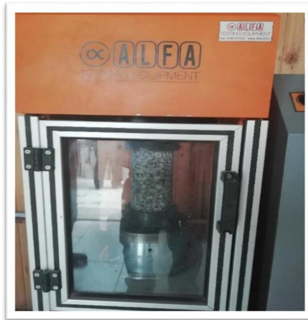
Ilustración 7: Rotura de probeta, ensayo de resistencia a compresión
