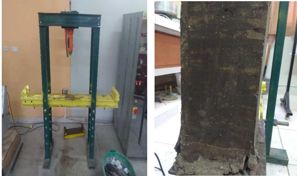
FOTO N°12: ENSAYO DE COMPRESIÓN DE MURETES
