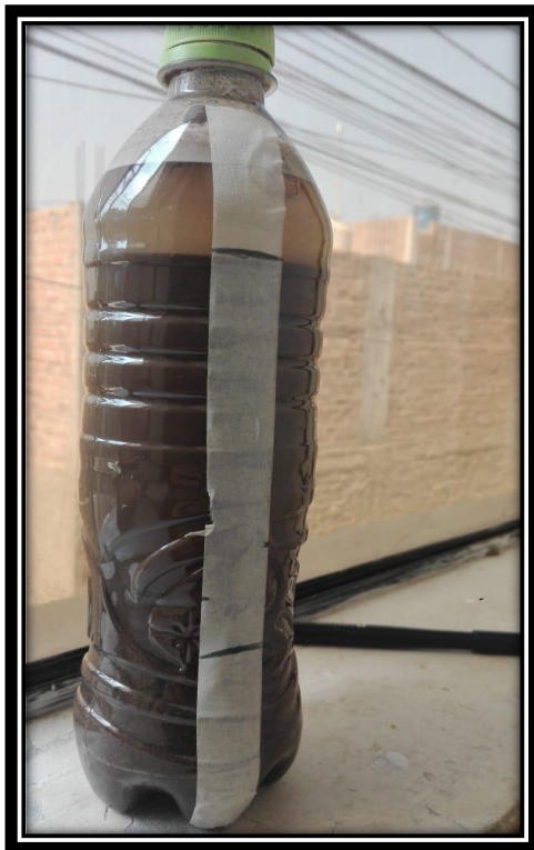
Foto N° 1: Tierra seleccionada con agua.
