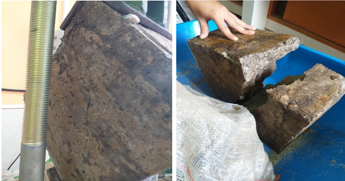
FOTO N°14: ENSAYO DE TRACCIÓN INDIRECTA DE MURETES
