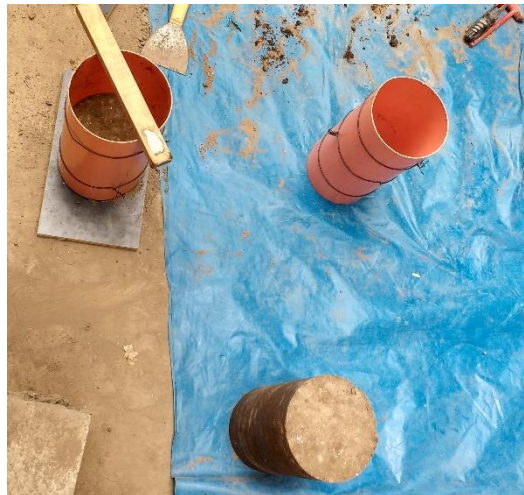
FOTO N°9: ELABORACIÓN DE CILINDROS DE 6''x12''
