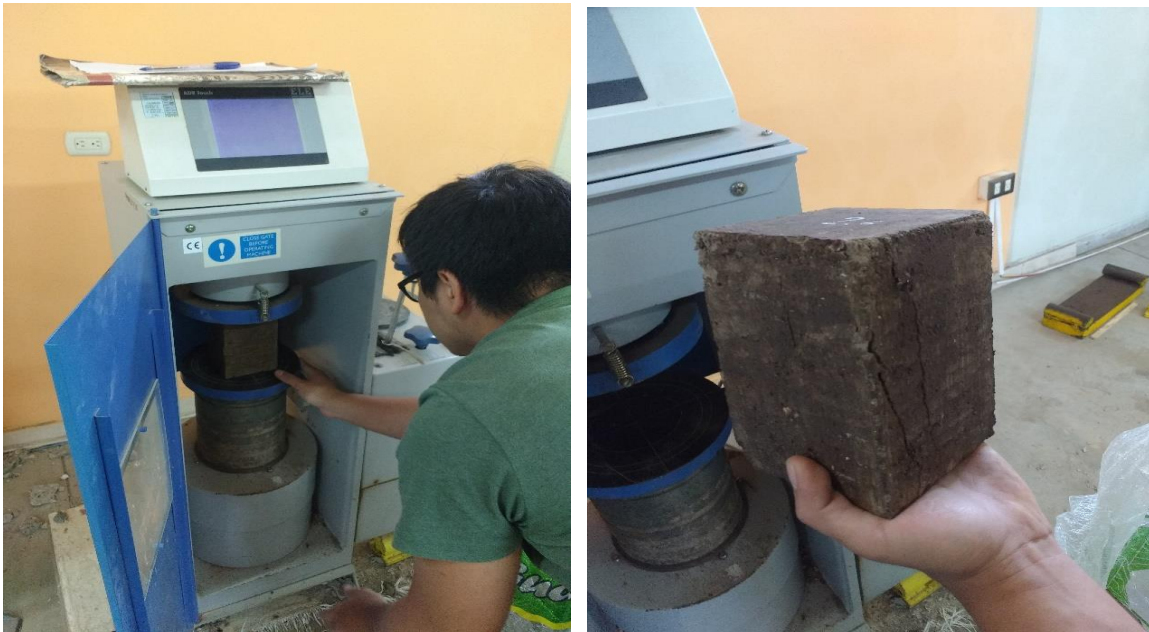
FOTO N°8: ENSAYO DE COMPRESIÓN
