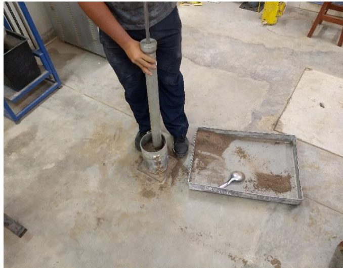
FIGURA N° 40: Proceso de compactación de muestra
