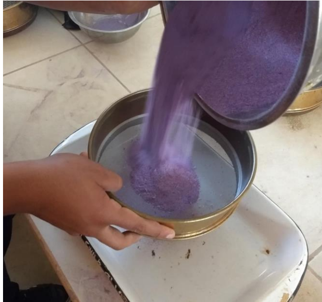
FIGURA N° 09: Tamizado del polímero EVA reciclado por la malla N° 30
