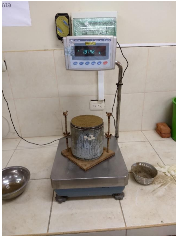
FIGURA N° 41: Registro de peso de los de los moldes
