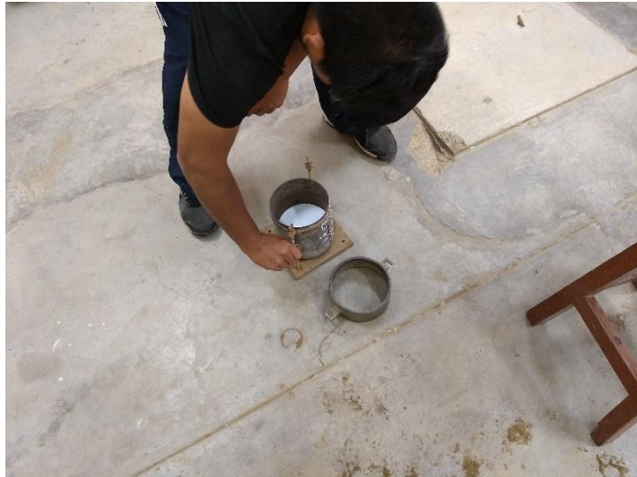
FIGURA N° 34: Armado del equipo de compactación
