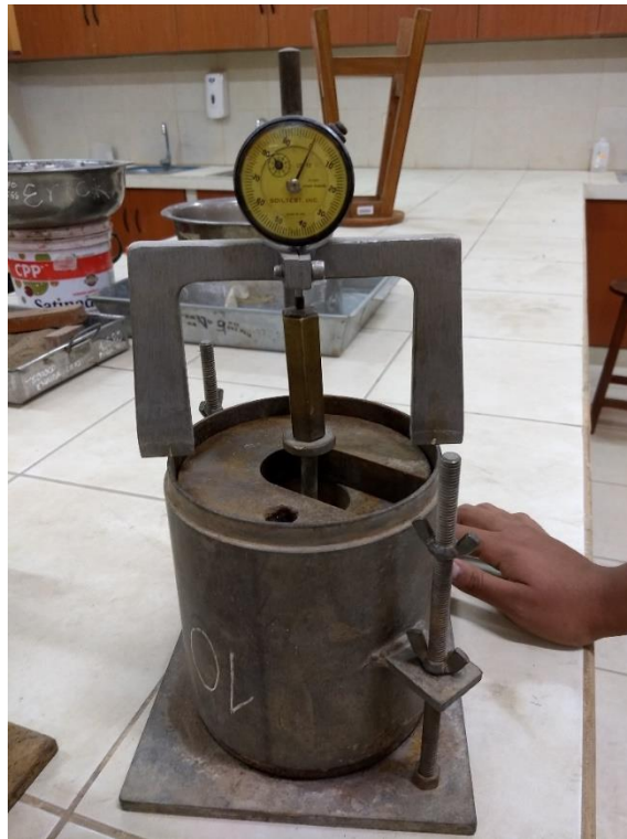
FIGURA N° 44: Colocación del deformímetro
