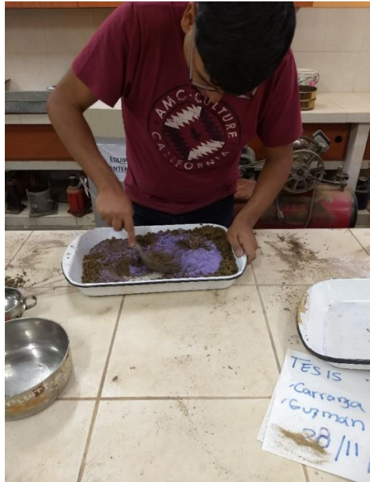
FIGURA N° 38: Mezclado de suelo, agua y polímero EVA en polvo
