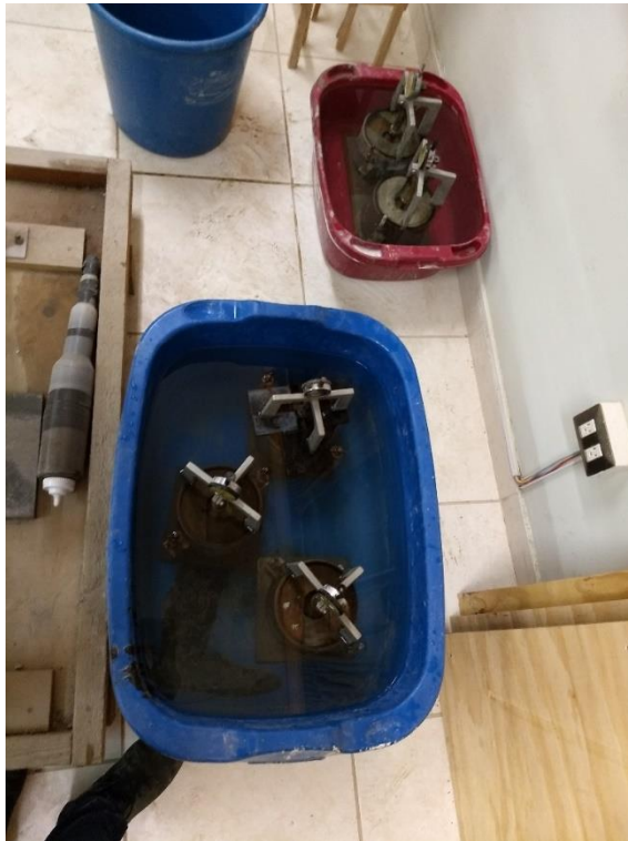
FIGURA N° 45: Sumergido de los moldes de CBR
