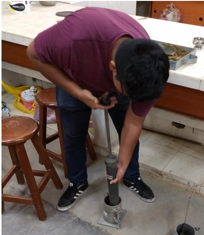
FIGURA N° 27: Proceso de compactación
