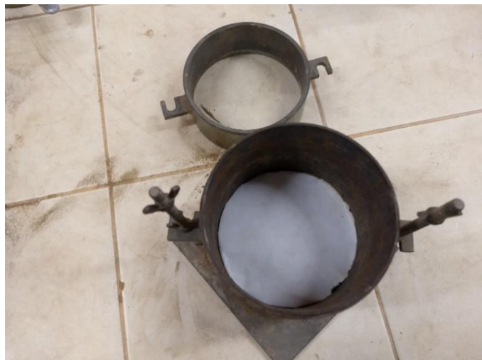
FIGURA N° 35: Colocado del papel filtro para evitar adherencia con el disco espaciador
