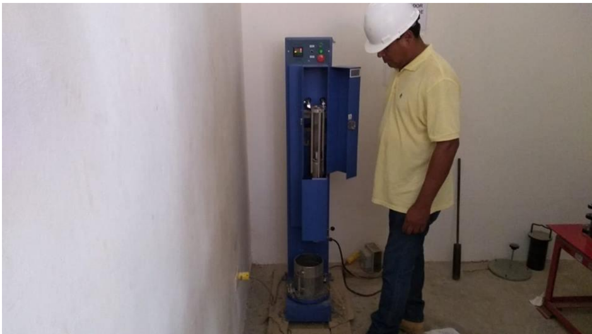
Fotografía 77. Ensayo de California Bearing Ratio con Cloruro de Magnesio Hexahidratado (Bischofita).
