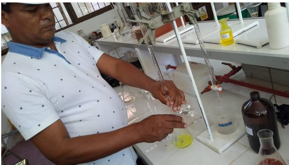
Fotografía 81. Adición del Reactivo con el Cloruro de Sodio II.
