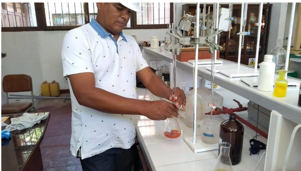
Fotografía 80. Adición del Reactivo con el Cloruro de Magnesio Hexahidratado (Bischofita) II.
