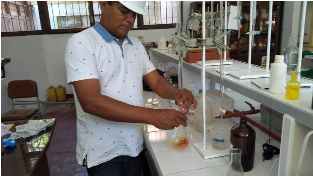
Fotografía 78. Adición del Reactivo con el Cloruro de Magnesio Hexahidratado (Bischofita) I.
