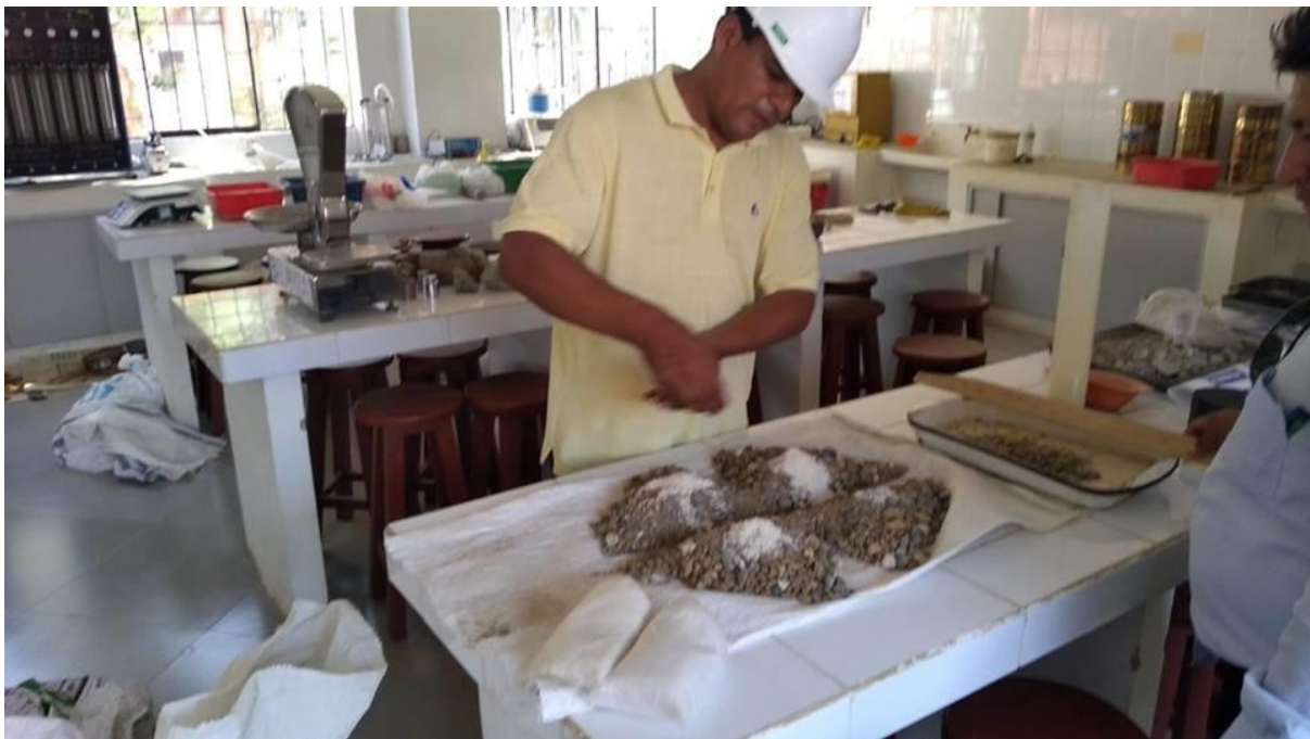
Fotografía 75. Adición de Cloruro de Magnesio Hexahidratado (Bischofita) II.
