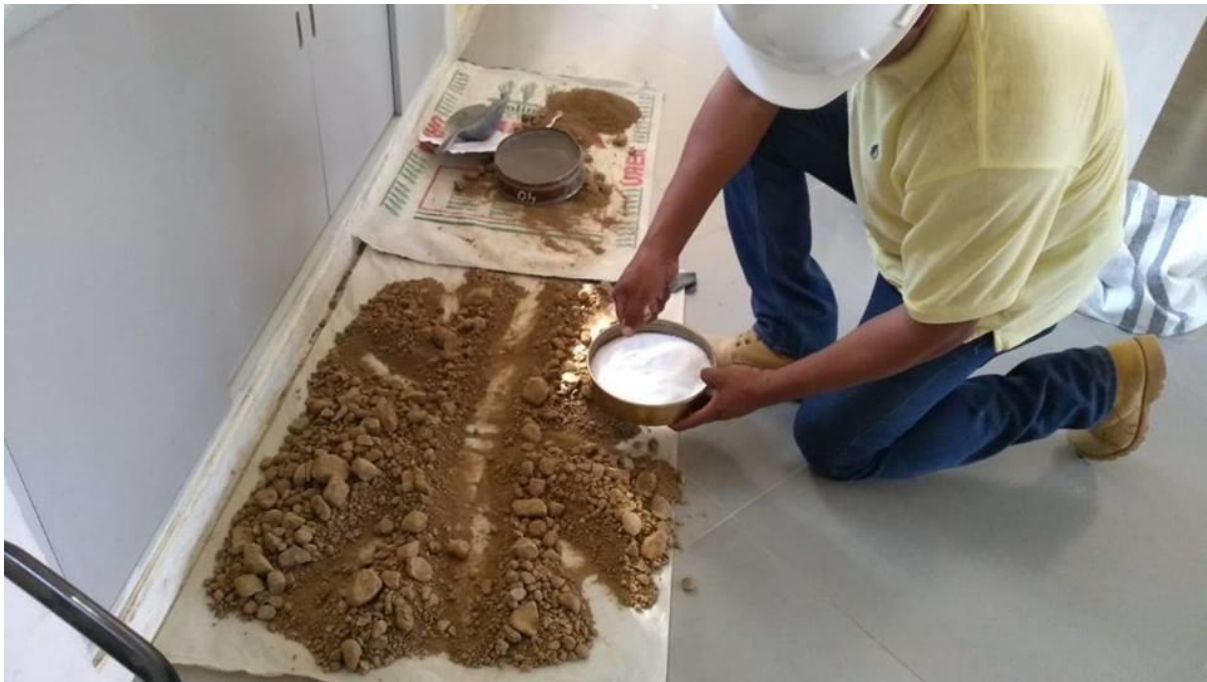
Fotografía 74. Adición de Cloruro de Magnesio Hexahidratado (Bischofita) I.
