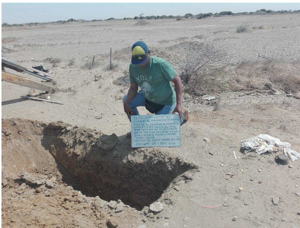
Fotografía 63. Exploración de campo, profundidad de 1.50m.
