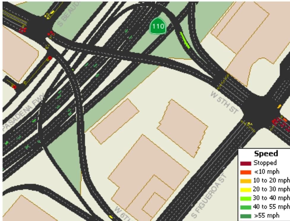
**Figura N° 06: Vista de modelo mediante el software TRANSMODELER**
