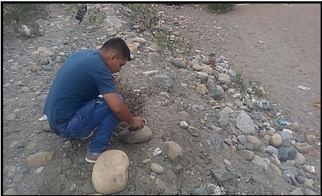
Imagen 14: Lectura de las Coordenadas UTM-WGS84 con ayuda del GPS GARMIN MAP 64S, para ubicar el BM en donde se va a ubicar la ESTACIÓN TOTAL TOPCON ES105.
