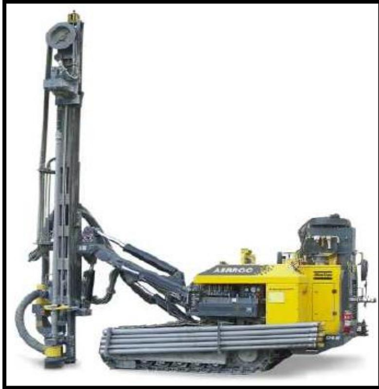
**Figura N° 11: Perforación rotatorio**
