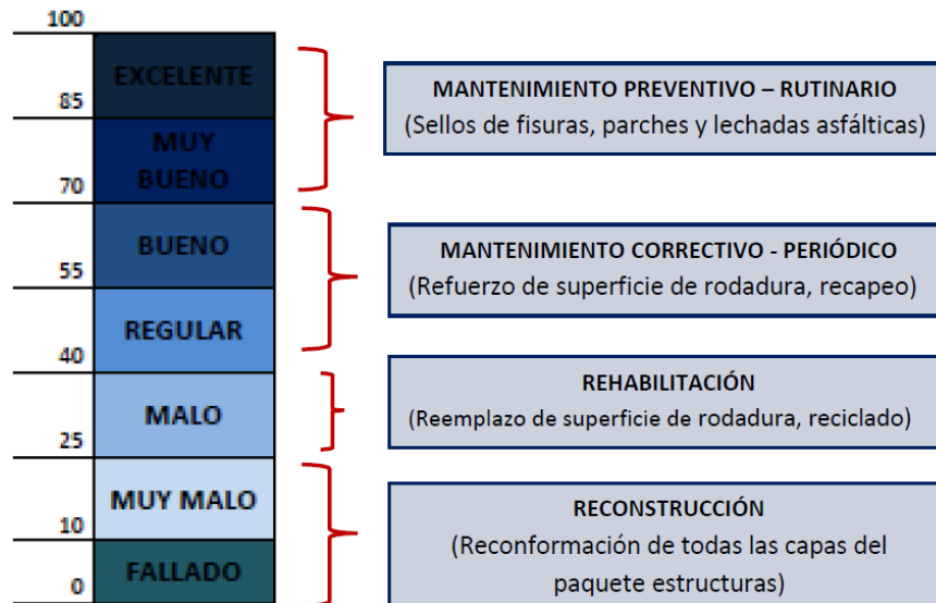
Figura 23: Escala De Graduación Y Tipo De Intervención Según Escala De P.C.I.
