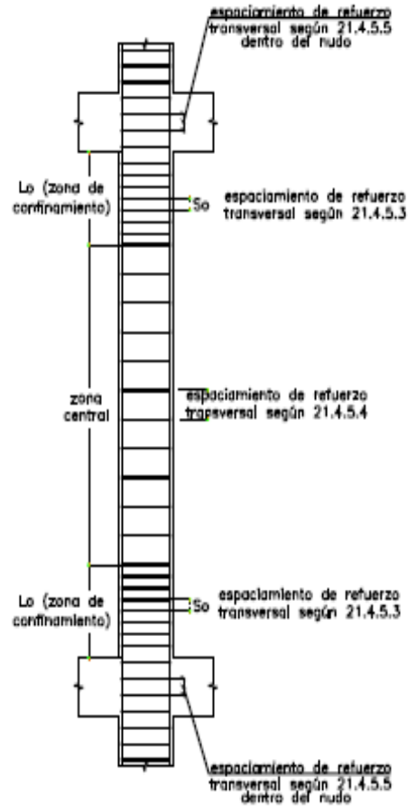
Figura 73: Requerimientos de estribos en columnas.
