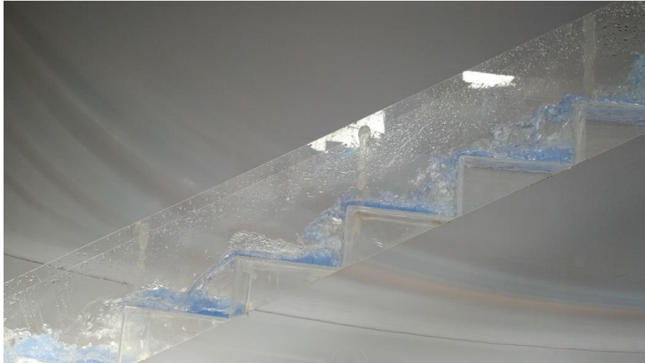
Ilustración 5. Flujo escalón a escalón en prototipo 01.
