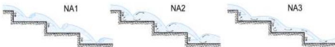
Figura 21. Tipos de flujo escalón en escalón
