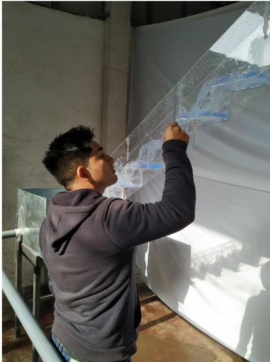
Ilustración 21. Medición de tirantes en el prototipo.
