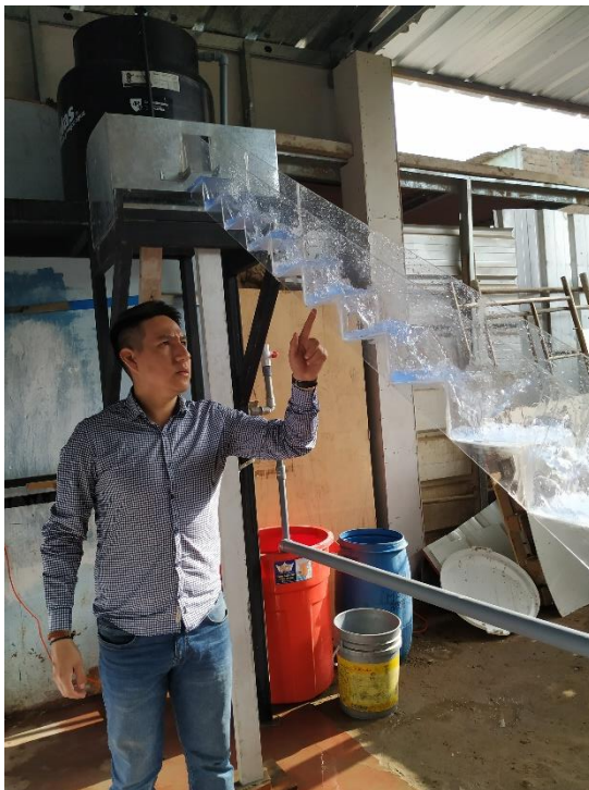
Ilustración 22. Evaluación del flujo de agua en el prototipo.
