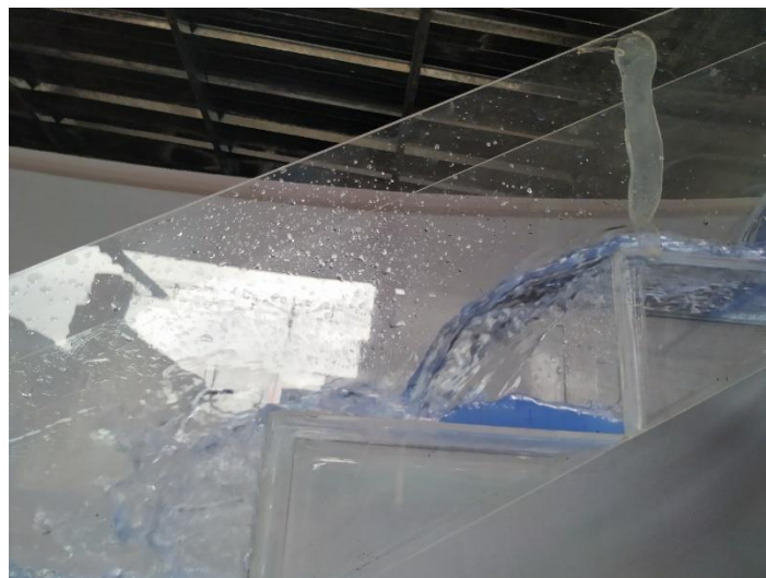
Ilustración 4. Flujo escalón a escalón. Fuente: Elaboración Propia
