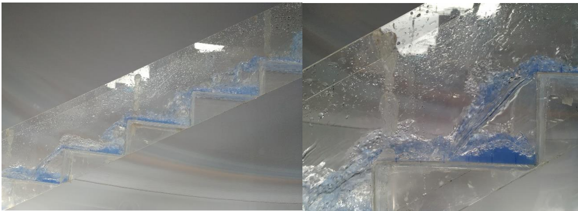
Figura 87. Comportamiento del Fluido en Modelo Experimental con un caudal de 0.00048m 3 /s P-01
