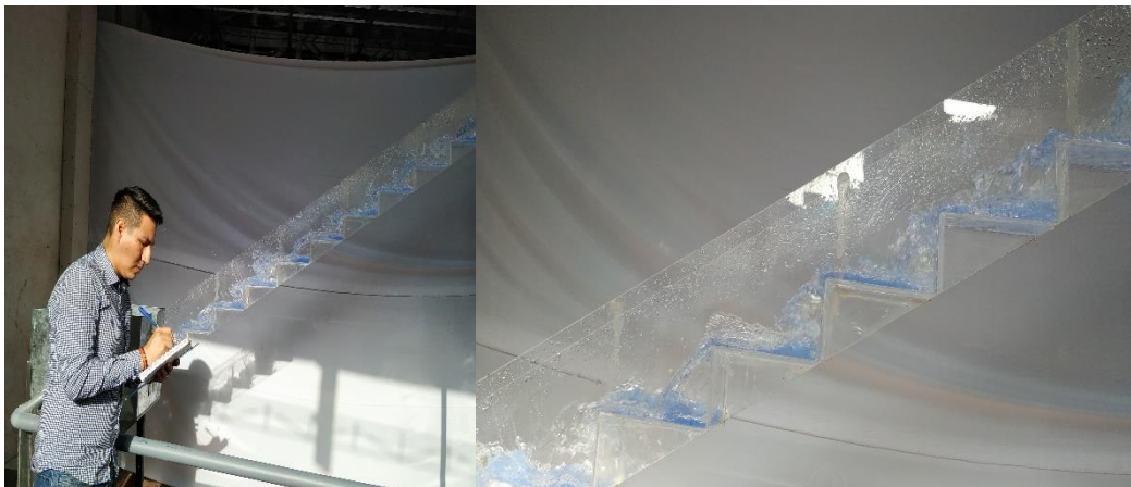
Ilustración 20. Toma de velocidades en el prototipo.
