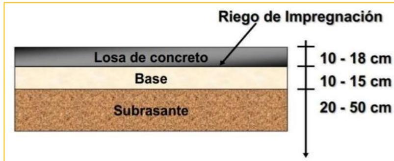
**Figura 05: Sección Transversal de un Pavimento Rígido**
