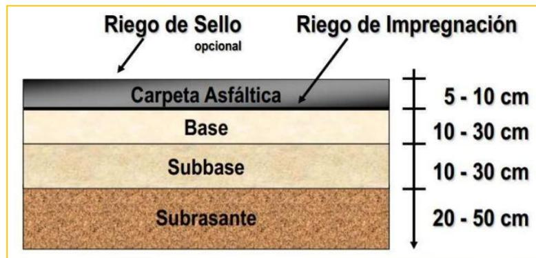
**Figura 04: Sección Transversal de un Pavimento Flexible**
