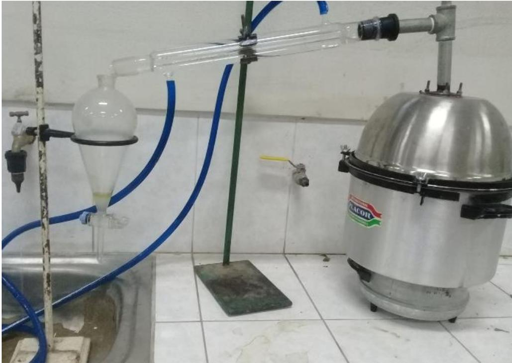
**Figura 05:** Método de “hidrodestilación”
