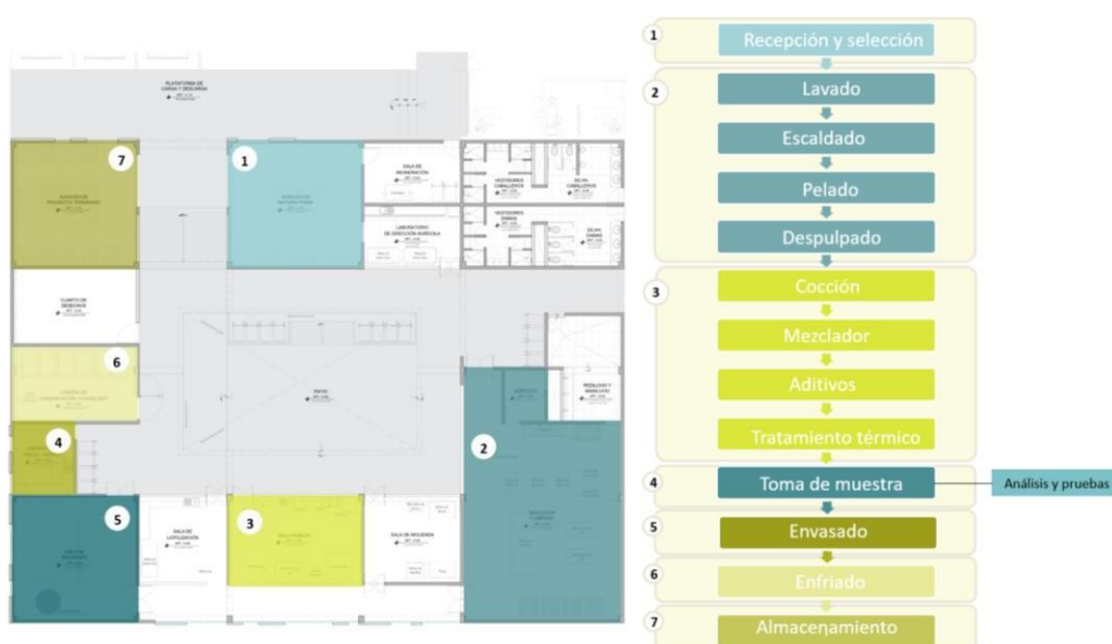
FIGURA 20: Diagrama de Flujo de Producción de Cóctel de Mango
