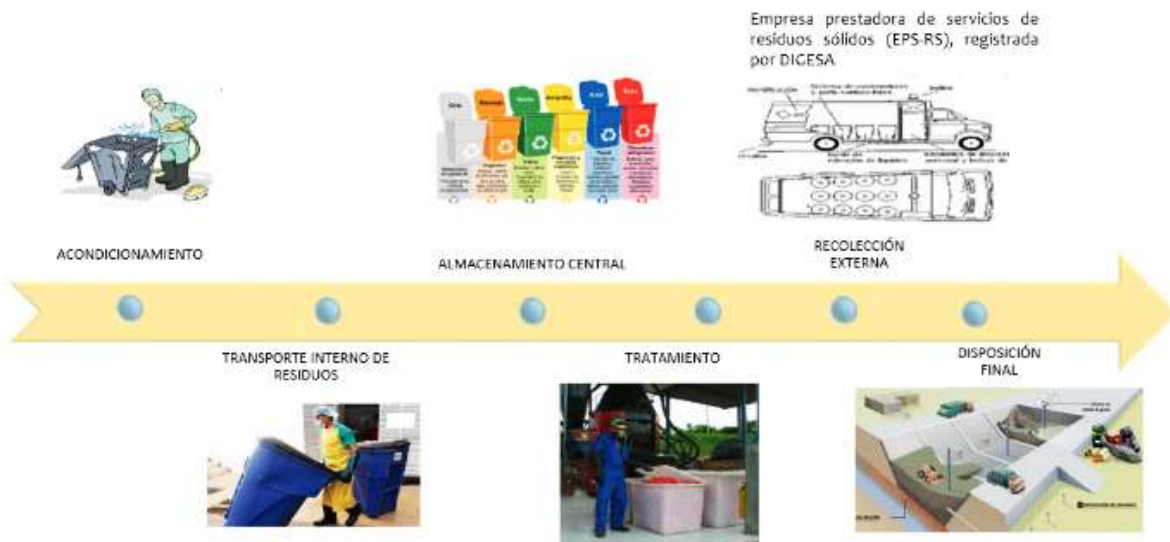
Figura N° 60 Esquema del Sistema de Eliminación de Residuos Sólidos del Hospital H II- 1 Pacasmayo
