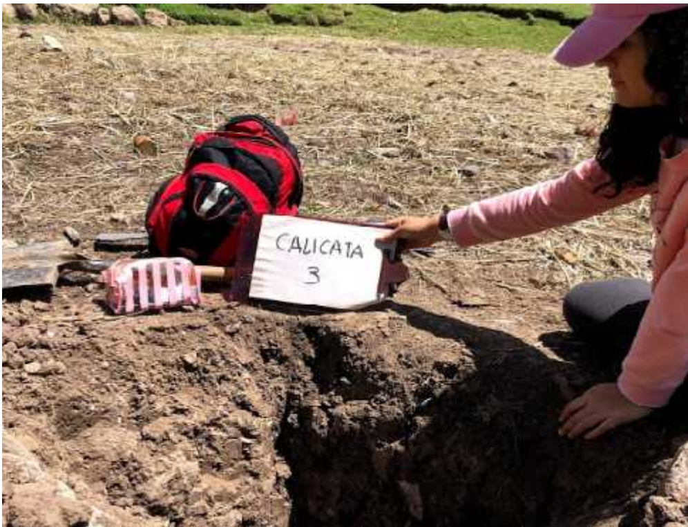
Foto N° 14: Calicata 3 (C-3), profundidad 1.50m
