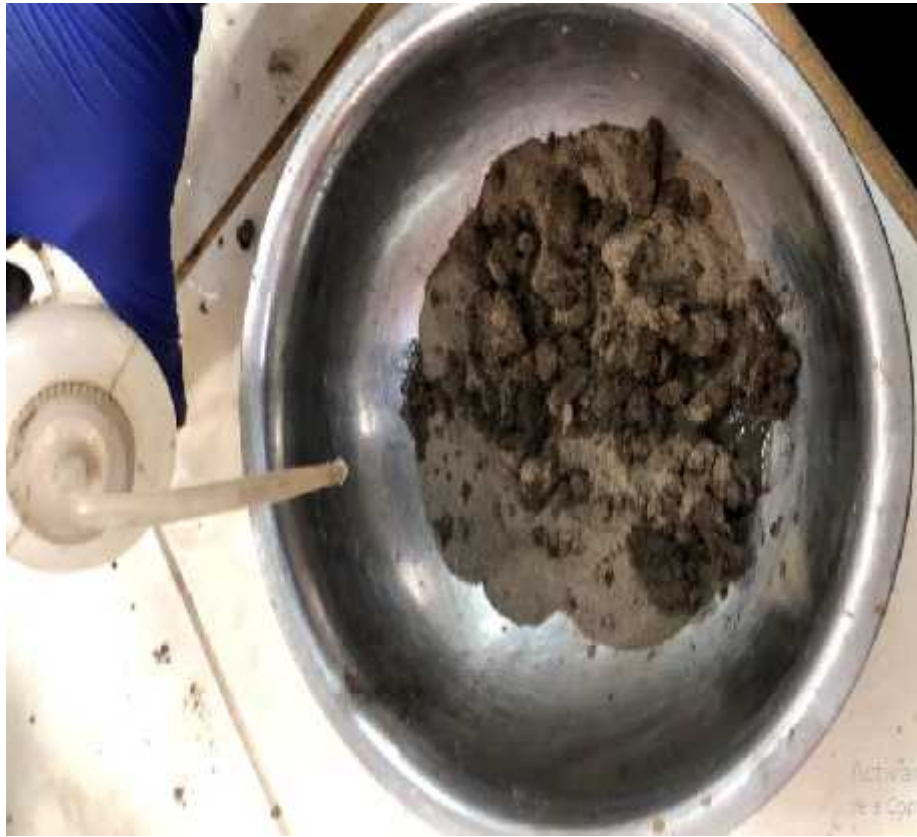
Foto N° 37: Colocación de agua en la mezcla. Límite líquido
