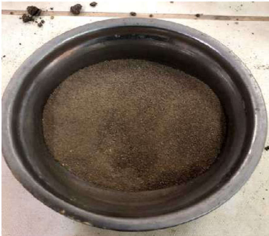
Foto N° 36: Muestra seca y tamizada por malla #40. Límite líquido
