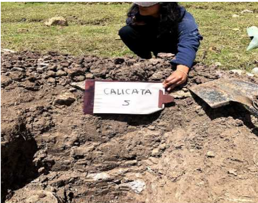
Foto N° 16: Calicata 5 (C-5), profundidad 1.50m
