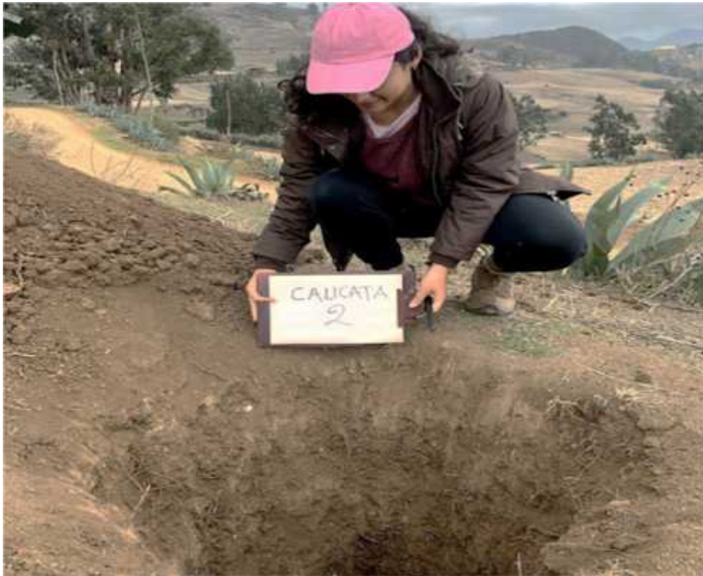
Foto N° 13: Calicata 2 (C-2), profundidad 1.50m
