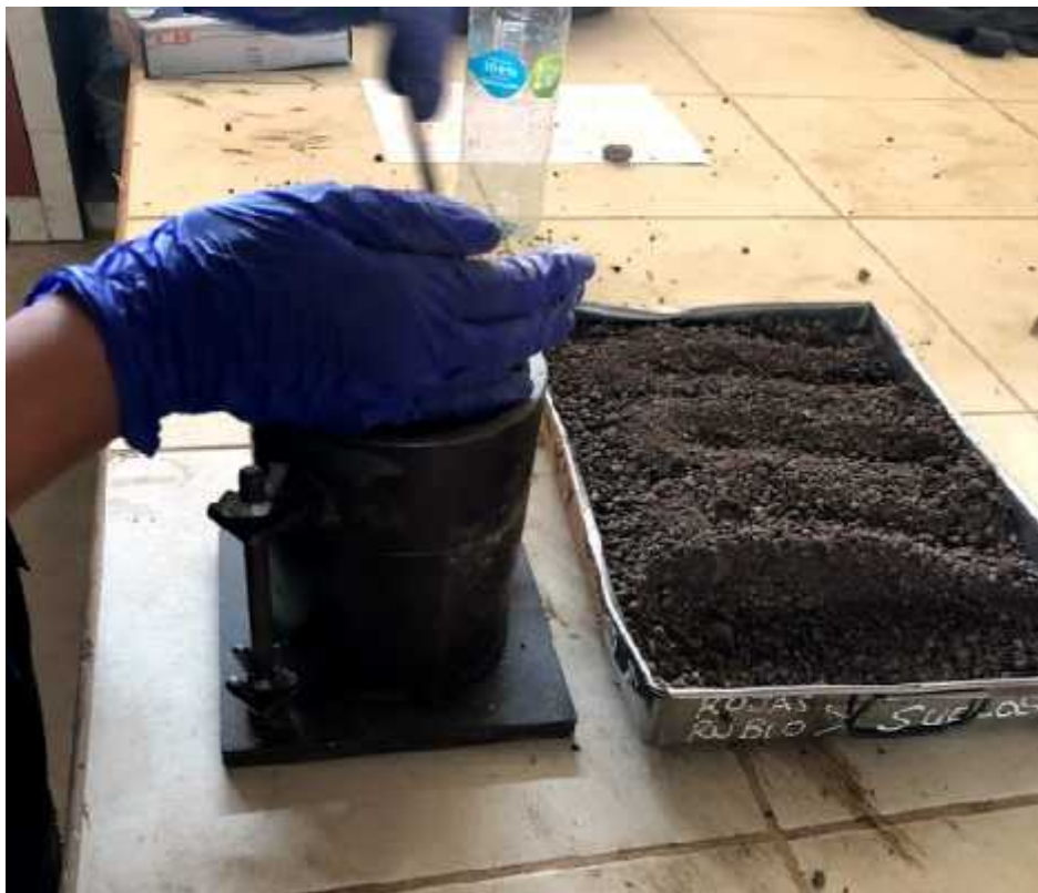
Foto N° 66: Dividimos la muestra para cinco capas y procedemos a llenar el molde. Proctor Modificado
