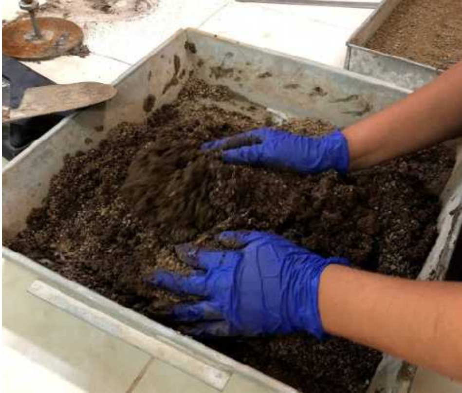
Foto N° 75: Conocido el óptimo contenido de humedad, aplicarlo a la muestra. CBR
