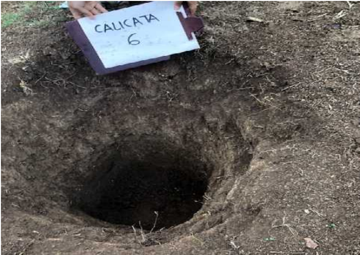
Foto N° 17: Calicata 6 (C-6), profundidad 1.50m
