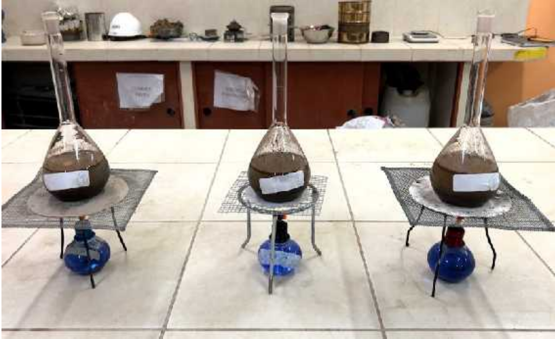
Foto N° 57: Muestras alcanzando su punto de ebullición. Gravedad específica
