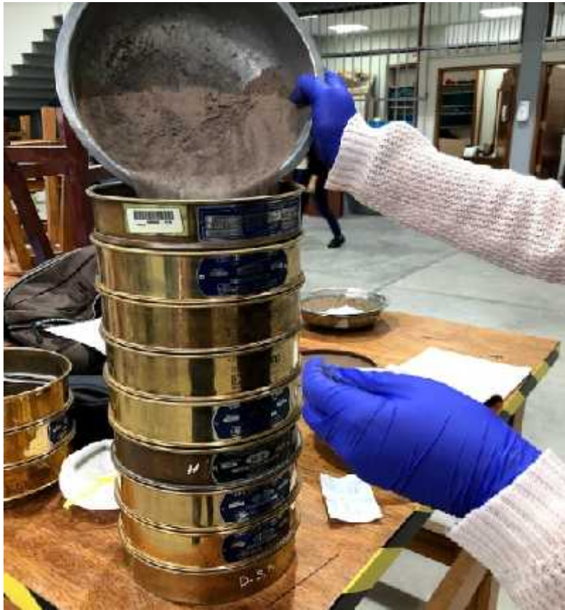
Foto N° 27: Muestra colocada en los tamices. Análisis Granulométrico por tamizado
