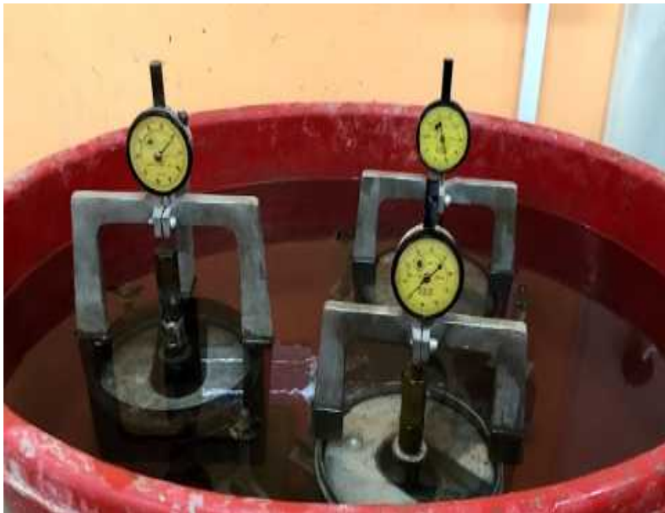
Foto N° 78: Colocación de deformímetro a cada muestra. CBR
