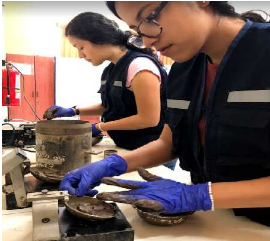
Foto N° 41: Tesistas colocando muestra en copa de Casagrande. Límite líquido
