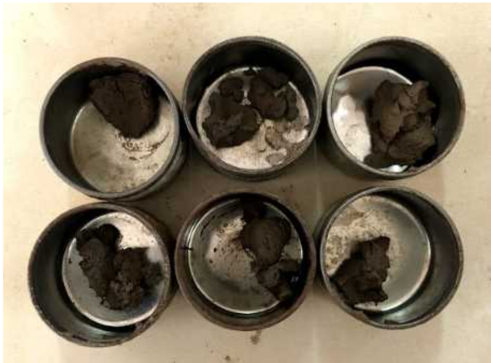
Foto N° 42: Muestras húmedas de límite líquido. Límite líquido
