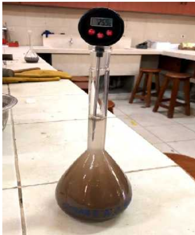
Foto N° 56: Control de temperatura de muestra + agua. Gravedad específica
