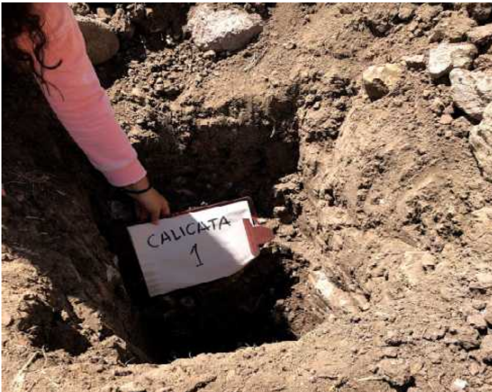
Foto N° 12: Calicata 1 (C-1), profundidad 1.50m
