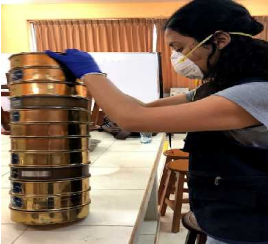
Foto N° 33: Agitación manual de la muestra. Análisis Granulométrico por tamizado
