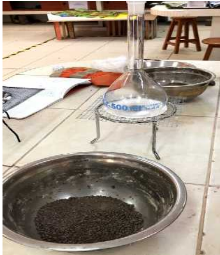
Foto N° 53: Muestra preparada antes de ser colocada en la fiola. Gravedad específica
