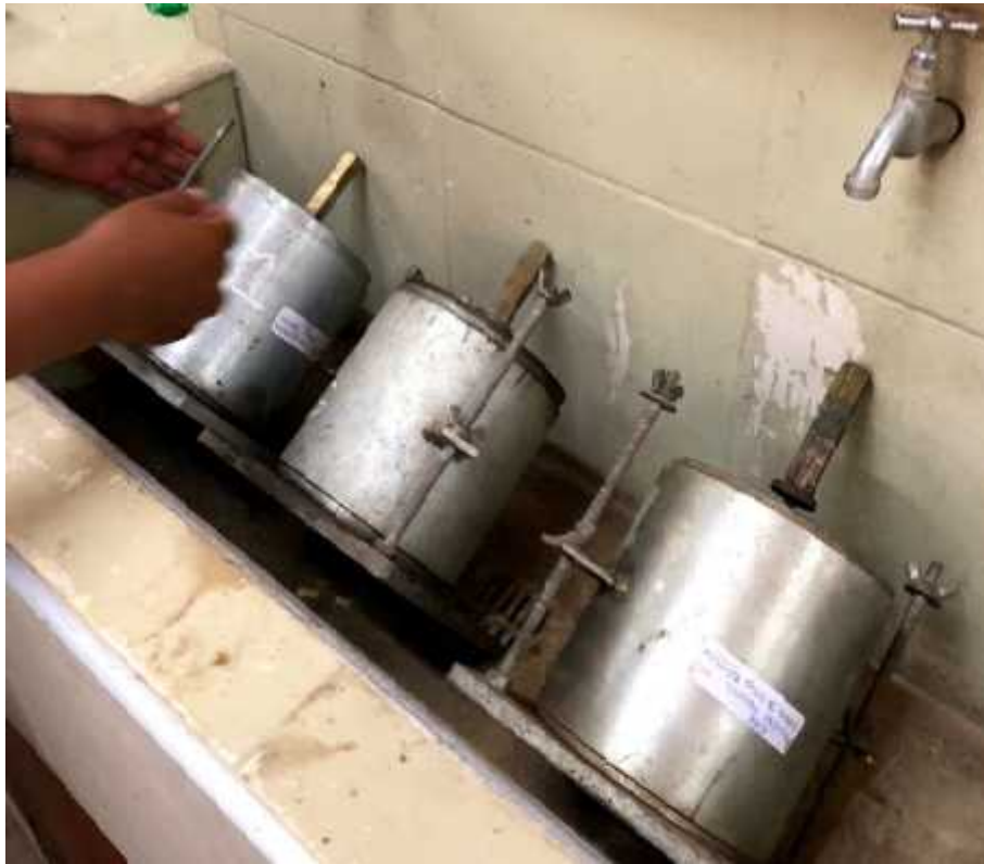
Foto N° 79: Transcurridos los 4 días, se retira la muestra del agua y se deja escurrir. CBR
