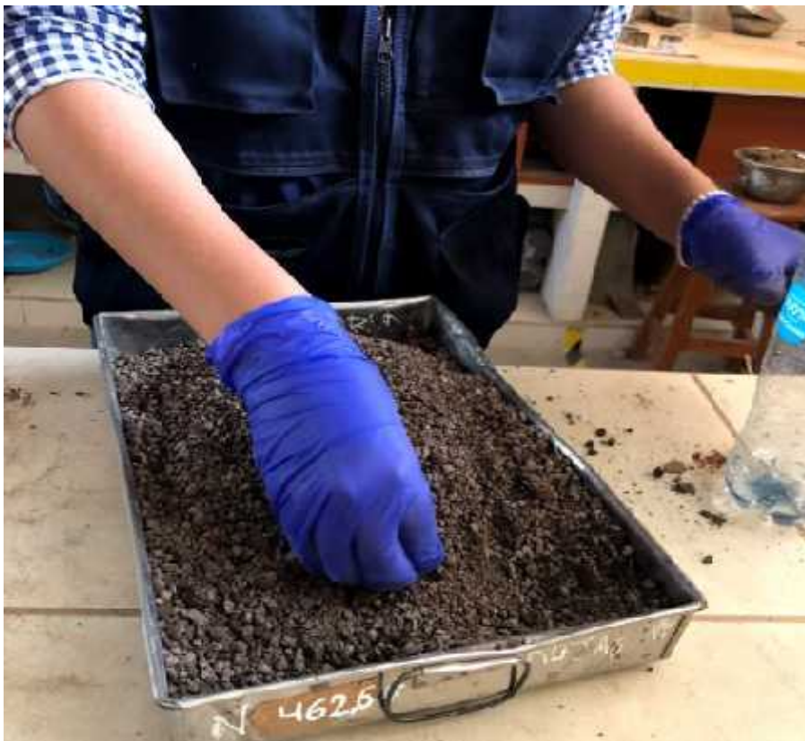
Foto N° 64: Mezclado homogéneo de muestra. Proctor Modificado
