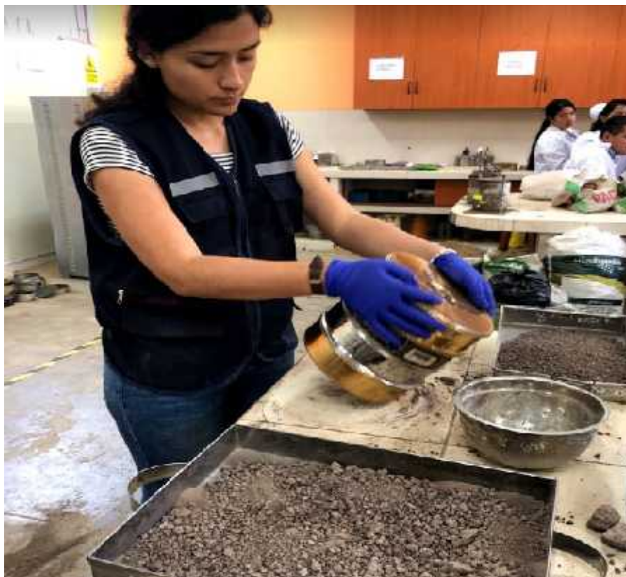
Foto N° 62: Previo secado, tamizar muestra por malla #4 y #3/8. Proctor Modificado
