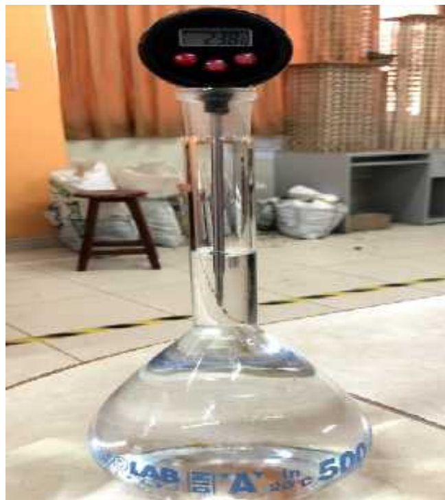
Foto N° 54: Medición de temperatura. Gravedad específica
