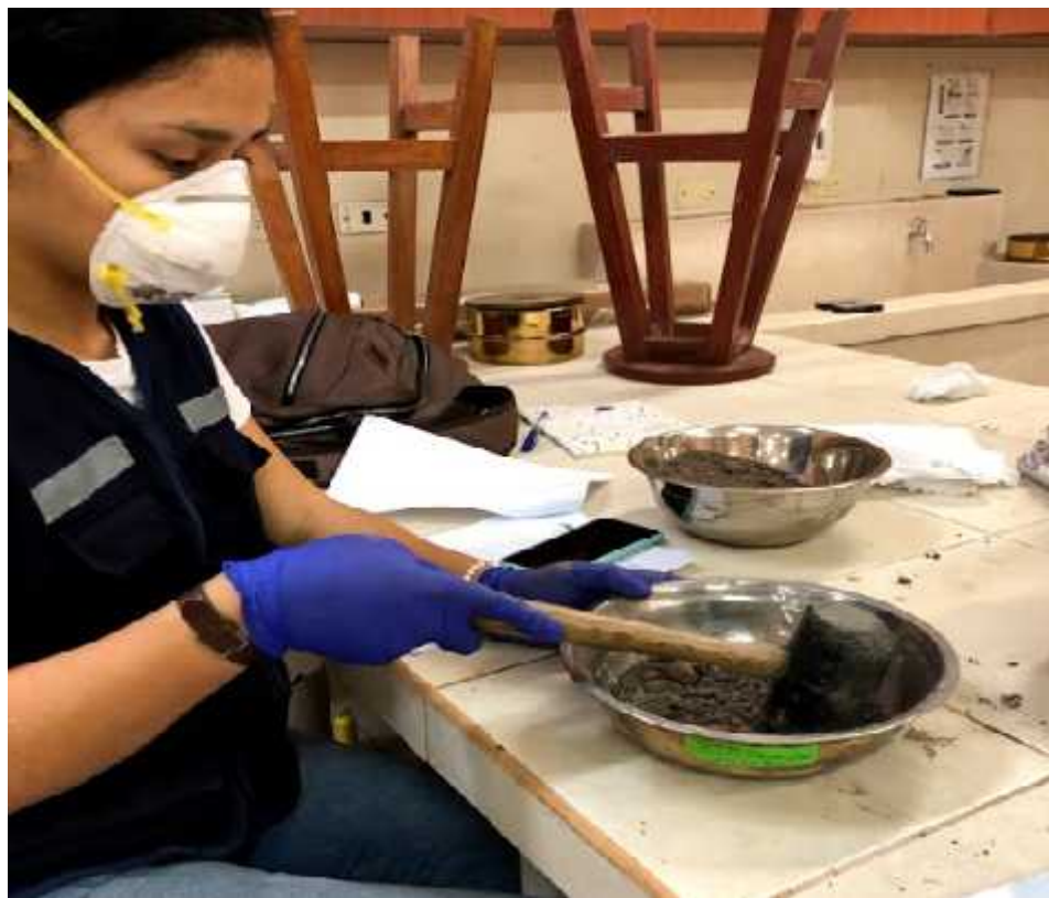
Foto N° 26: Preparación de muestras. Análisis Granulométrico por tamizado
