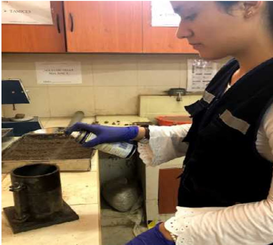
Foto N° 65: Preparamos el molde rociándole lubricante. Proctor Modificado
