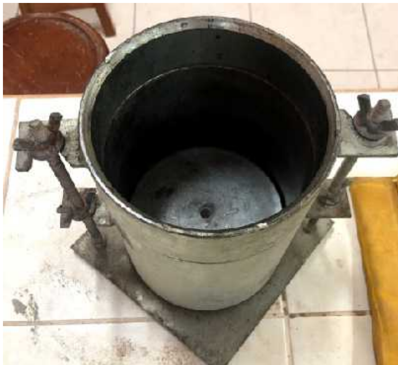
Foto N° 72: Preparación de molde para CBR. CBR
