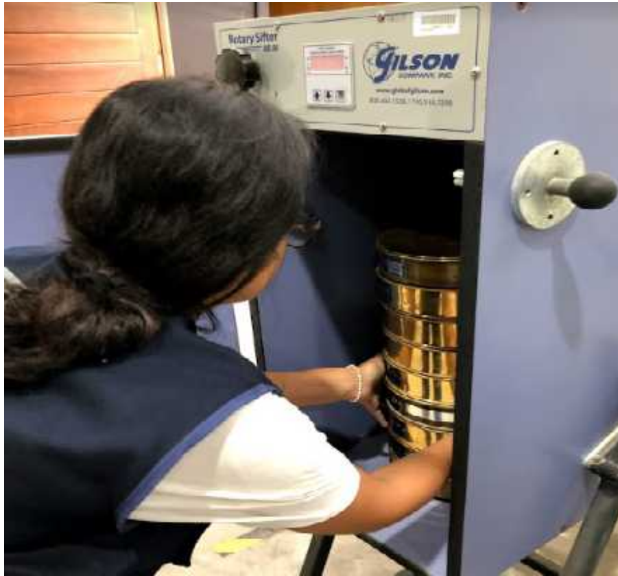
Foto N° 29: Colocación de tamices en agitador mecánico. Análisis Granulométrico por tamizado
