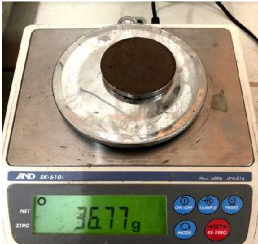
Foto N° 51: Peso de muestra húmeda. Límite de contracción
