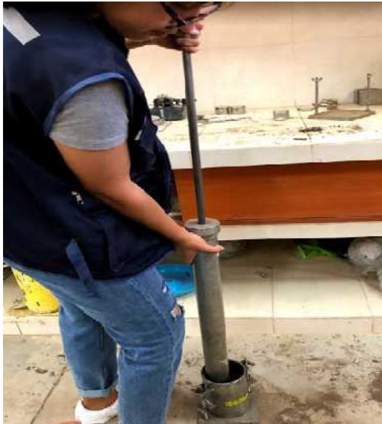
Foto N° 67: Compactar cada capa con pistón. Proctor Modificado
