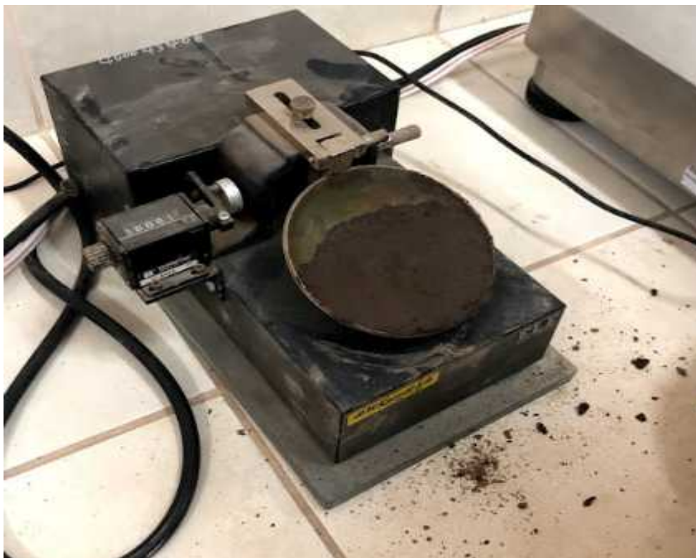
Foto N° 39: Suelo preparado en copa de Casagrande. Límite líquido
