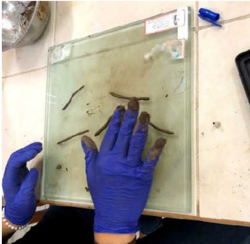
Foto N° 45: Moldeado de cilindros. Límite plástico
