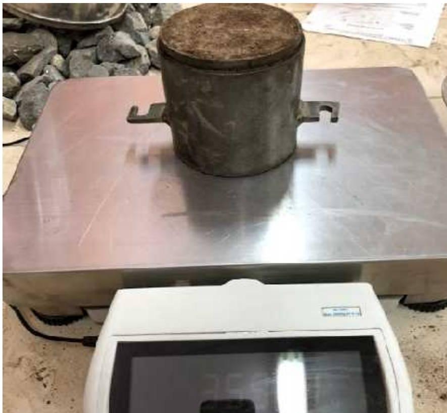
Foto N° 70: Peso de muestra + molde. Proctor Modificado
