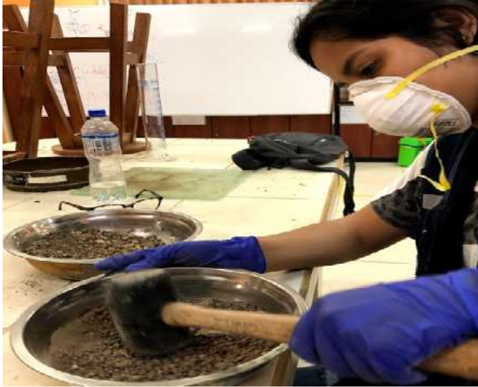
Foto N° 25: Preparación de muestras. Análisis Granulométrico por tamizado
