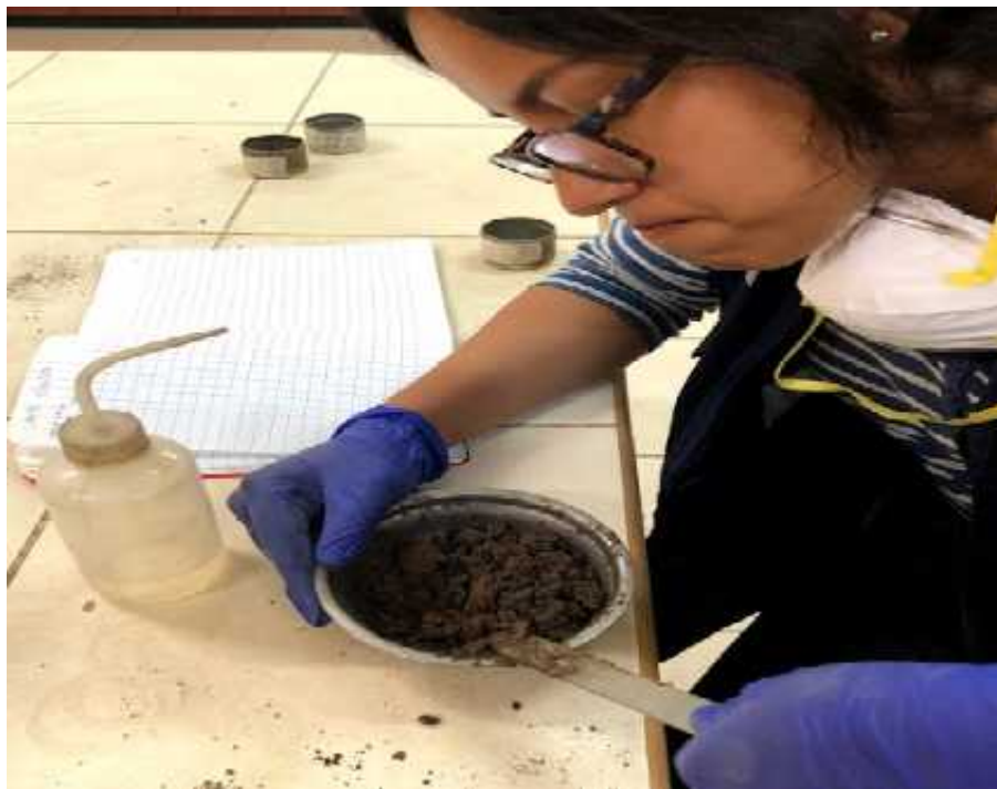
Foto N° 38: Mezcla homogénea de muestra y agua. Límite líquido
