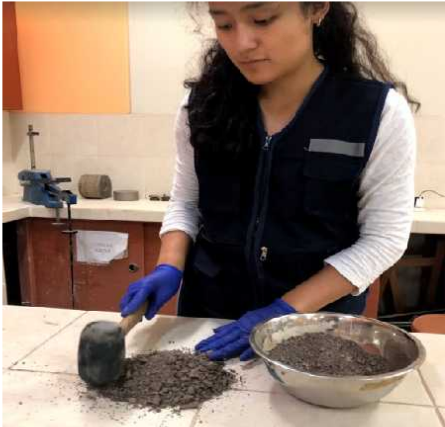
Foto N° 35: Preparación de la muestra. Límite líquido
