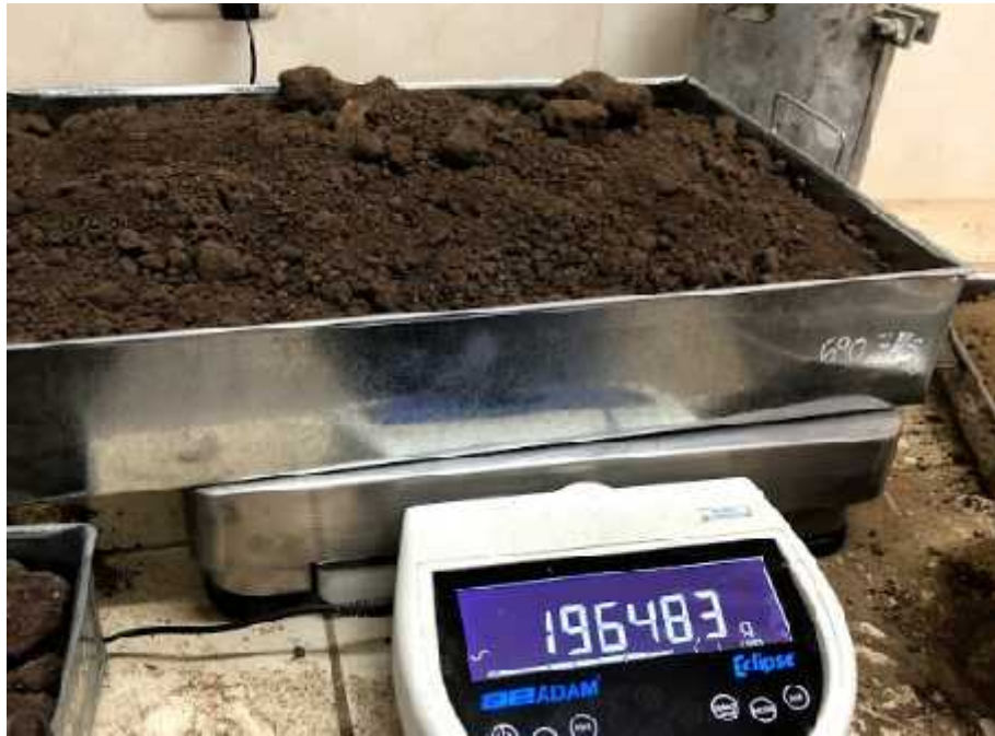
Foto N° 61: Selección de muestra para cuatro ensayos. Proctor Modificado
