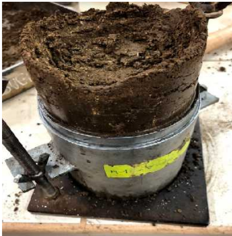
Foto N° 68: Retirar el collarín una vez terminadas las cinco capas. Proctor Modificado
