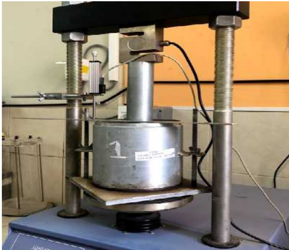
Foto N° 80: Se procede al ensayar la muestra CBR
