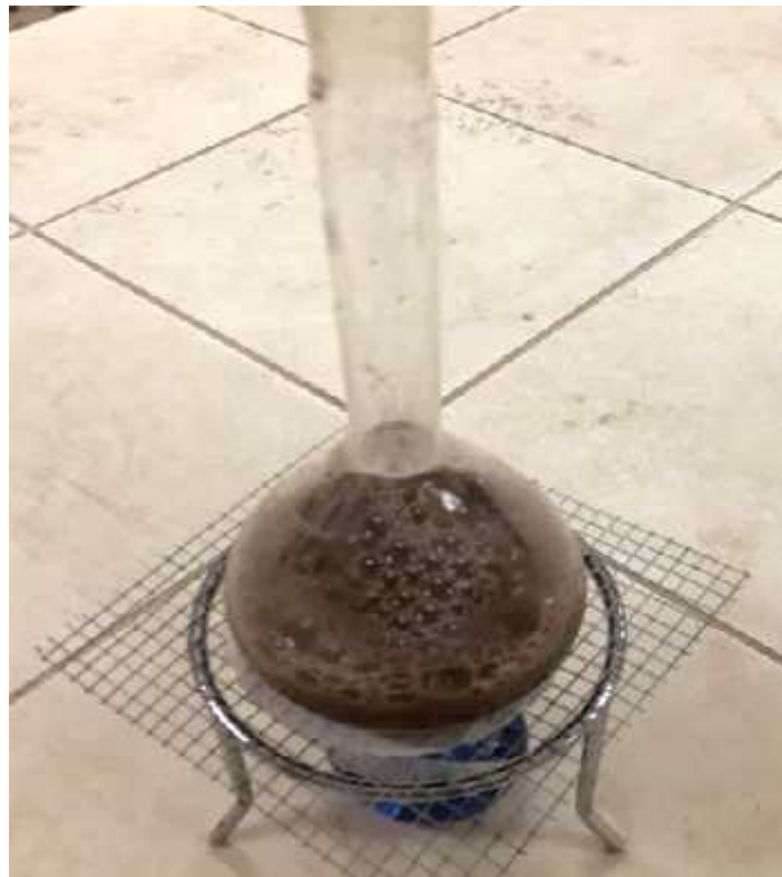
Foto N° 58: Muestra + agua alcanzando su punto de ebullición. Gravedad específica
