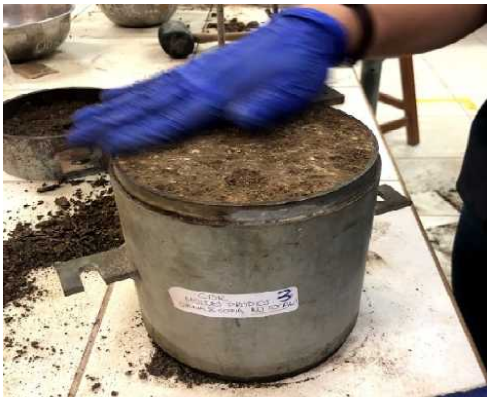
Foto N° 76: Colocar cinco capas al molde y compactar cada una de ellas con 12, 25 o 56 golpes. CBR
