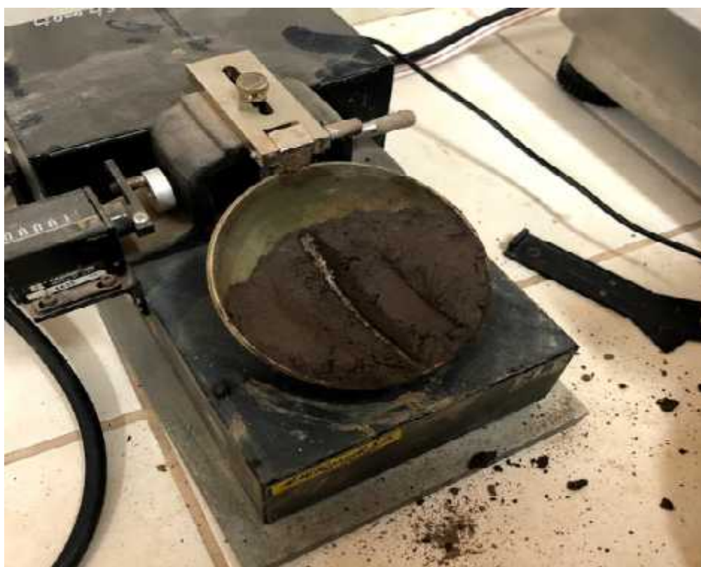
Foto N° 40: Muestra dividida por acanalador. Límite líquido
