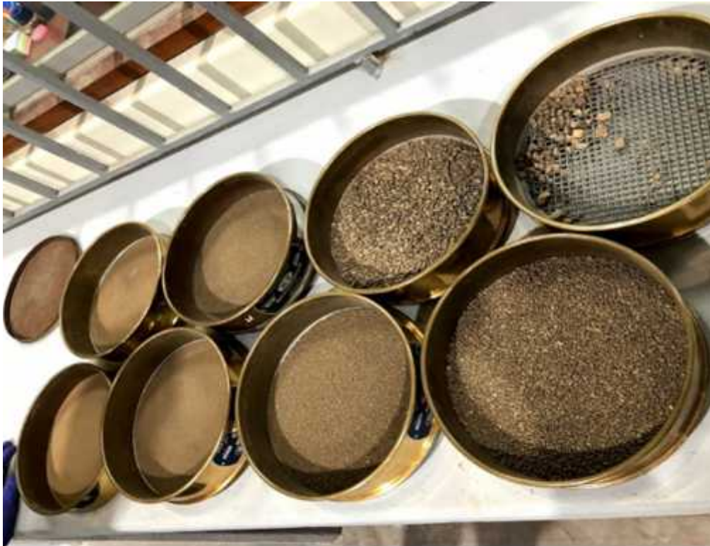
Foto N° 31: Muestra tamizada. Análisis Granulométrico por tamizado
