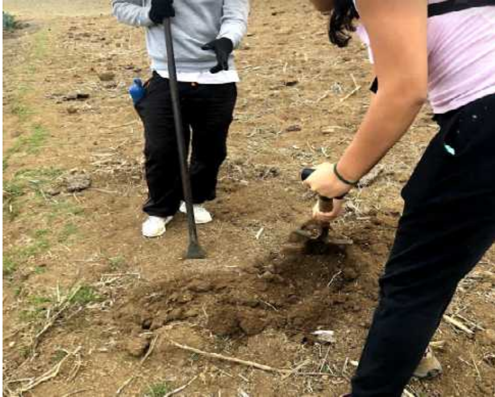
Foto N° 9: Excavación de calicatas
