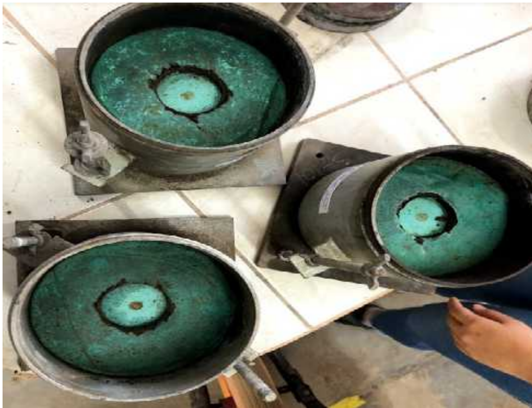
Foto N° 81: Muestras después de haber sido ensayadas. CBR
