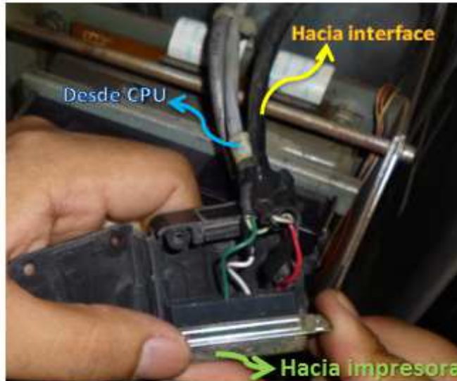
Figura 3.10: Toma de Señales desde conector de impresora
