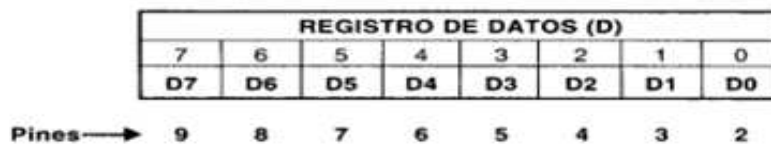
Figura 2.1: Registro de datos del puerto paralelo en la PC o Site Controller y los pines correspondientes en el conector DB-25
