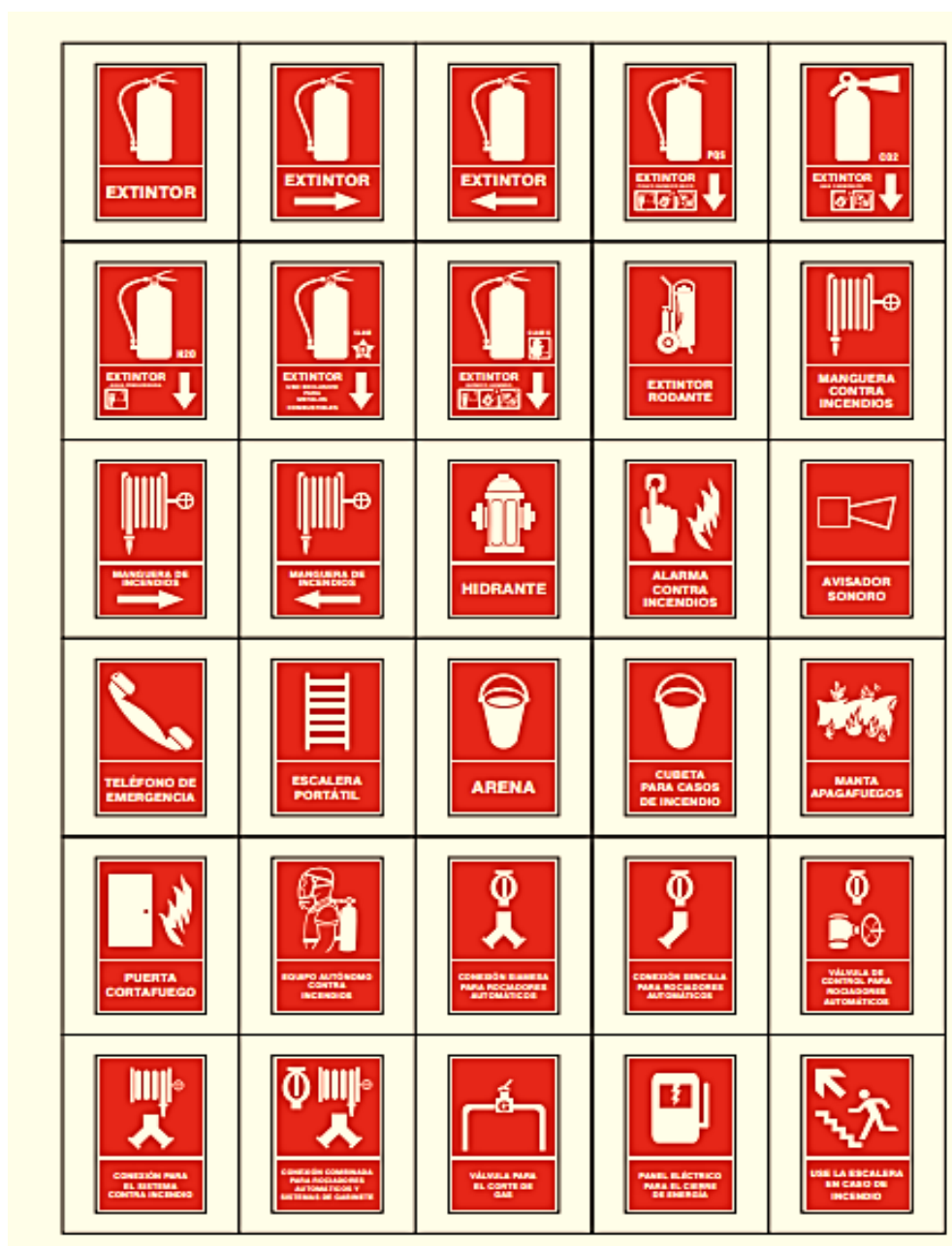
Imagen N° 52: Carteles para Equipos Contra Incendios
