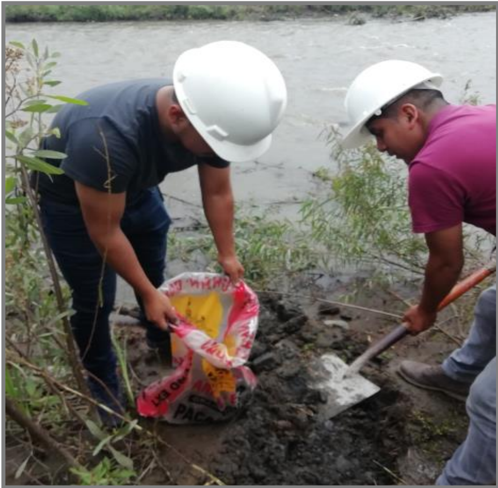
Imagen 20 – Toma de la muestra de material sedimentario Fuente: Autoría propia
