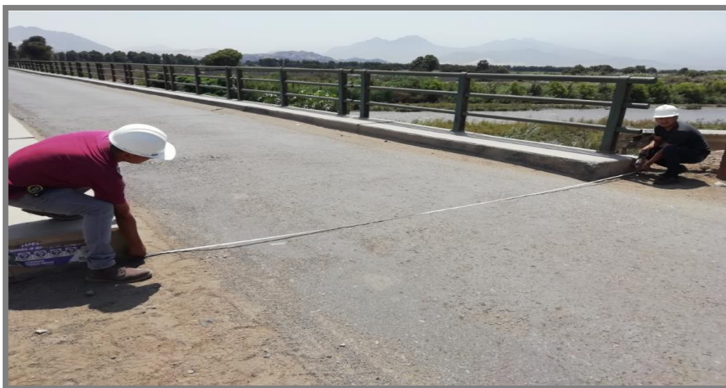
Imagen 17 – Vista en perspectiva – Toma de medidas del tablero. Fuente: Autoría propia
