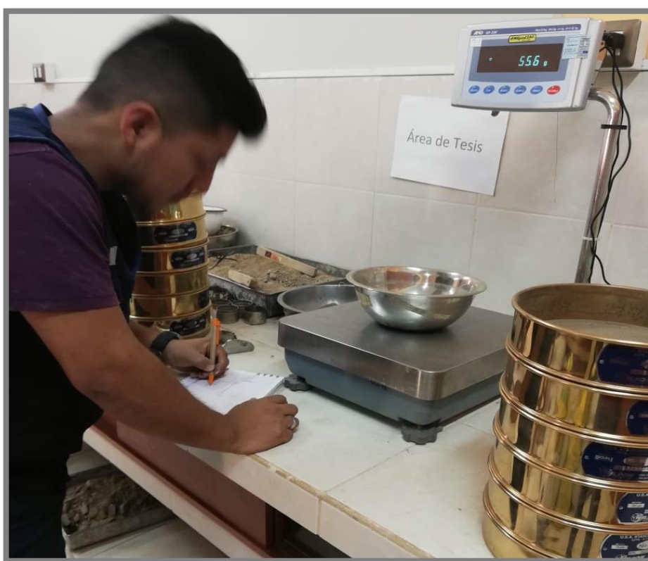
Imagen 24 – Ensayo granulométrico en laboratorio UPAO. Fuente: Autoría propia
