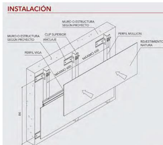
Imagen 44: Detalle de revestimiento acústico.
