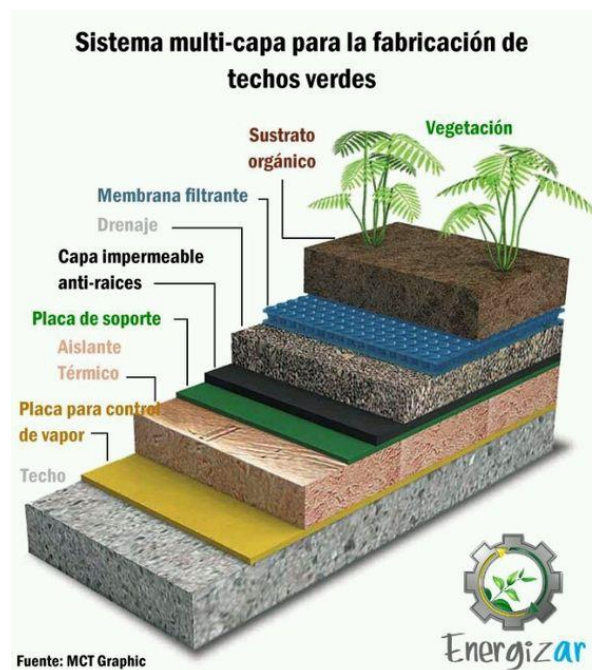
Imagen 37: Detalle de instalación de techo verde.
