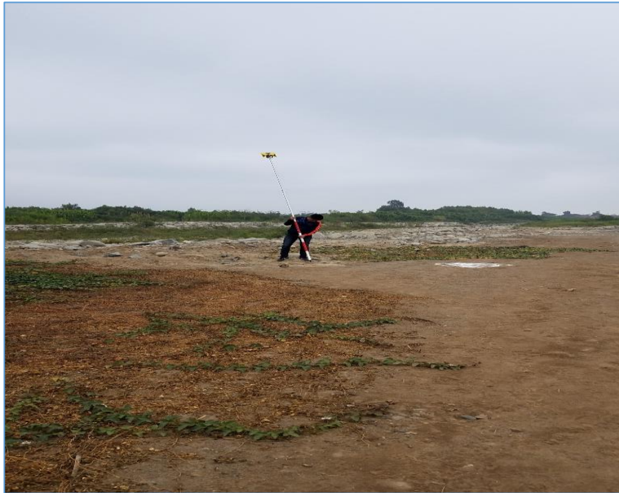
Figura N° 75: lectura de los puntos de control en ambos márgenes del río Chicama cada 500 m
