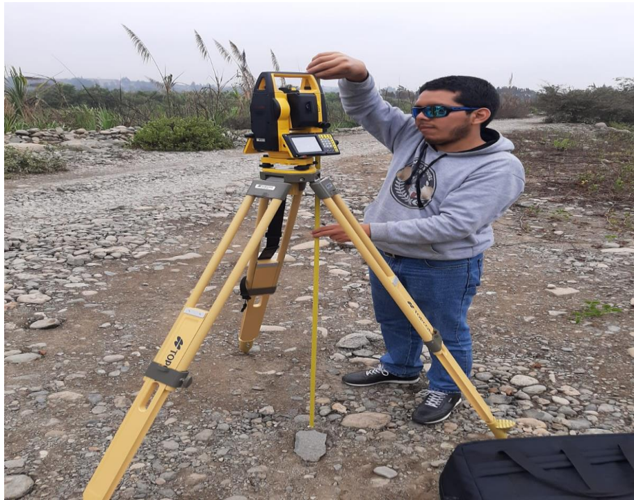
Figura N° 73: colocación de la estación total
