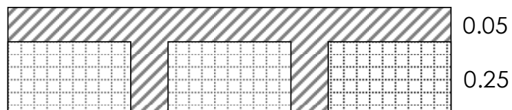
Figura N° 100: Detalle Sección de Losa e= 0.30 m.
