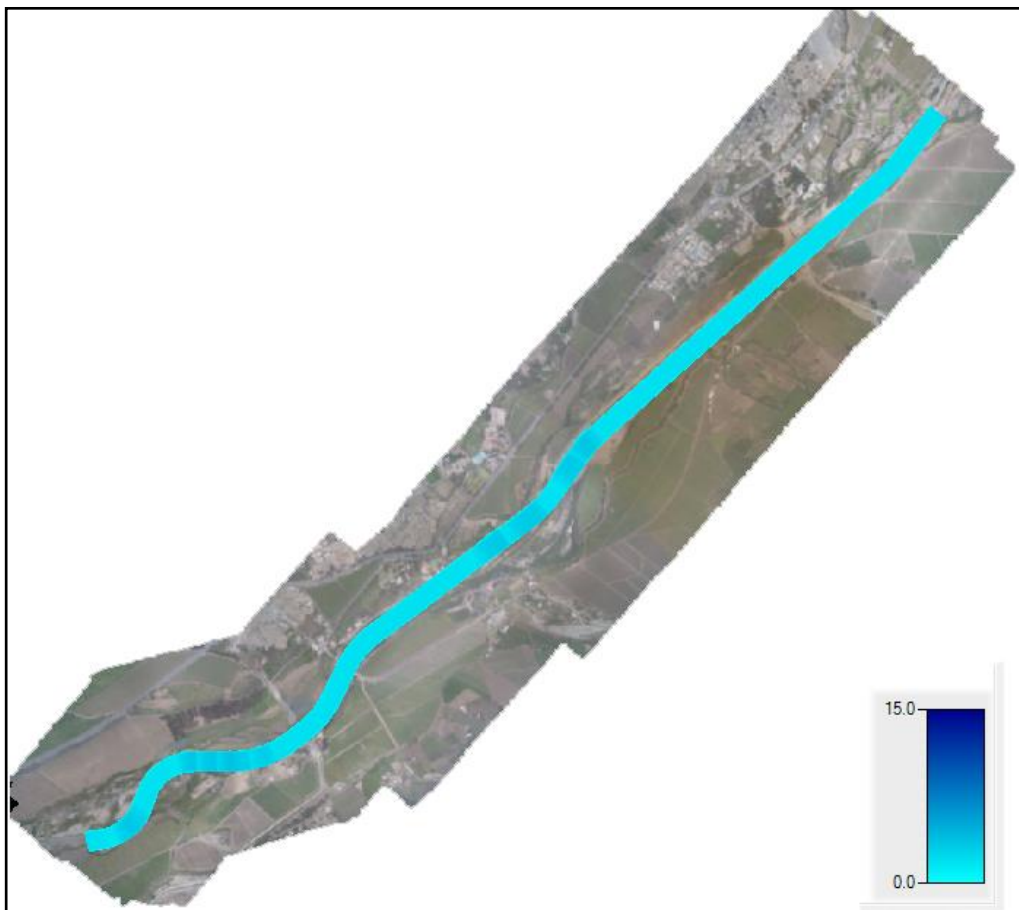
Figura 21 Calado con Dique de Protección
