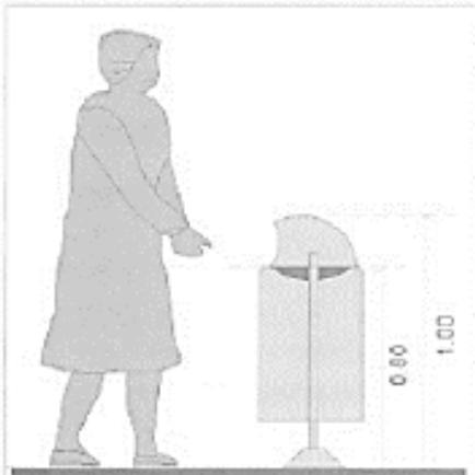
Los basureros deben instalarse en el borde exterior de la acera y su diseño debe permitir su fácil utilización por todo tipo de personas, para lo cual su boca debe tener una altura de entre 80 y 100 cm.
