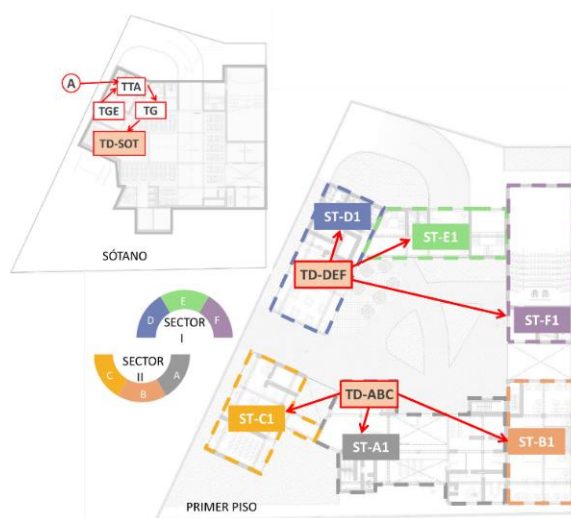
Fig. N° 78: Planteamiento general de tableros de distribución Fuente: Propia
