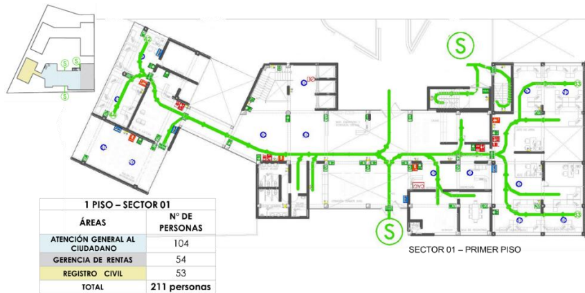
Fig. N° 82: Sector 01 – Evacuación primer piso – Ruta 1°
