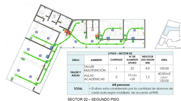
Fig. N° 93: Sector 02 – Evacuación Segundo piso – Ruta 3°
