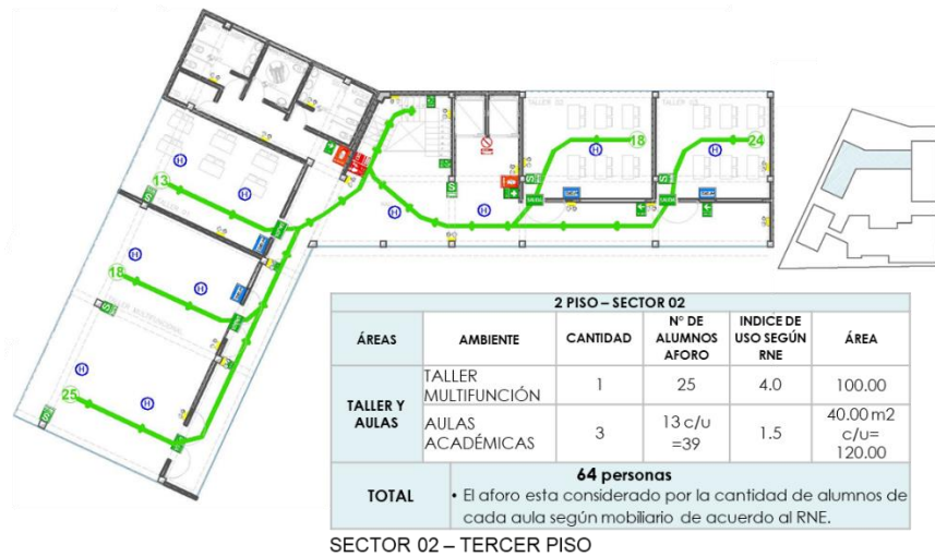
Fig. N° 94: Sector 02 – Evacuación Tercer piso – Ruta 3°
