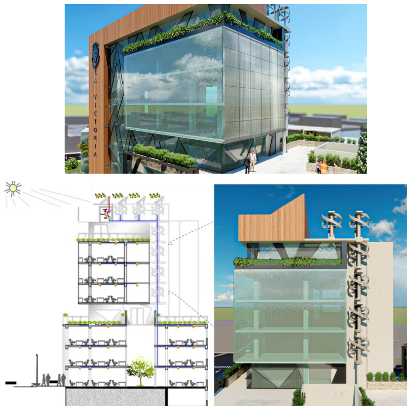
Fig. N° 73: Esquema de captación, transformación y distribución de Paneles Fotovoltaicos y Mini generadores eólicos urbanos - Fuente: Elaboración Propia
