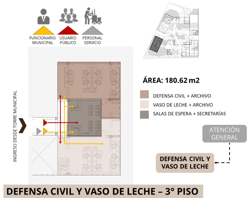
Fig. N° 67: Zona de Defensa Civil y Vaso de Leche 3° piso Fuente: Elaboración Propia
