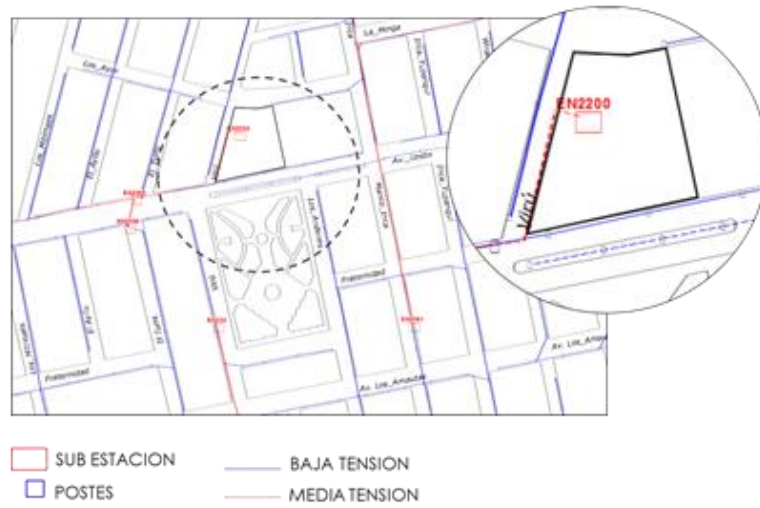
Fig. N° 36: Puntos de acceso para red eléctrica Fuente: Electro Norte S.A
