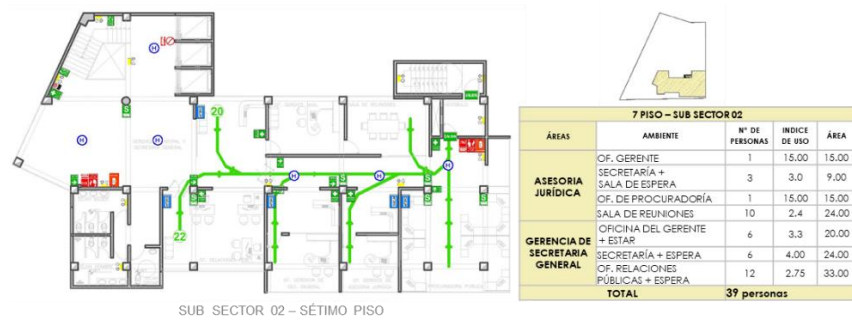
Fig. N° 90: Sector 01 – Evacuación sub sector 2 – Séptimo piso – Ruta 1°
