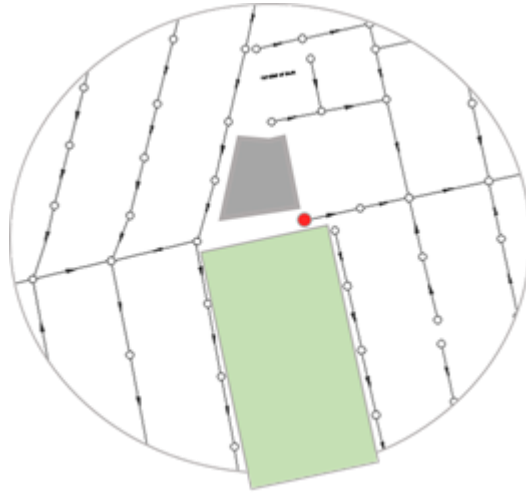
Fig. N° 35: Punto de conexión para red de agua y alcantarillado Fuente: EPSEL
