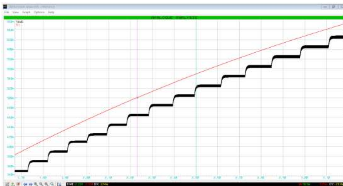
Figura 108 Respuesta transitoria en PROSPICE para un factor de convergencia a 0.01 y número de coeficientes a 10
