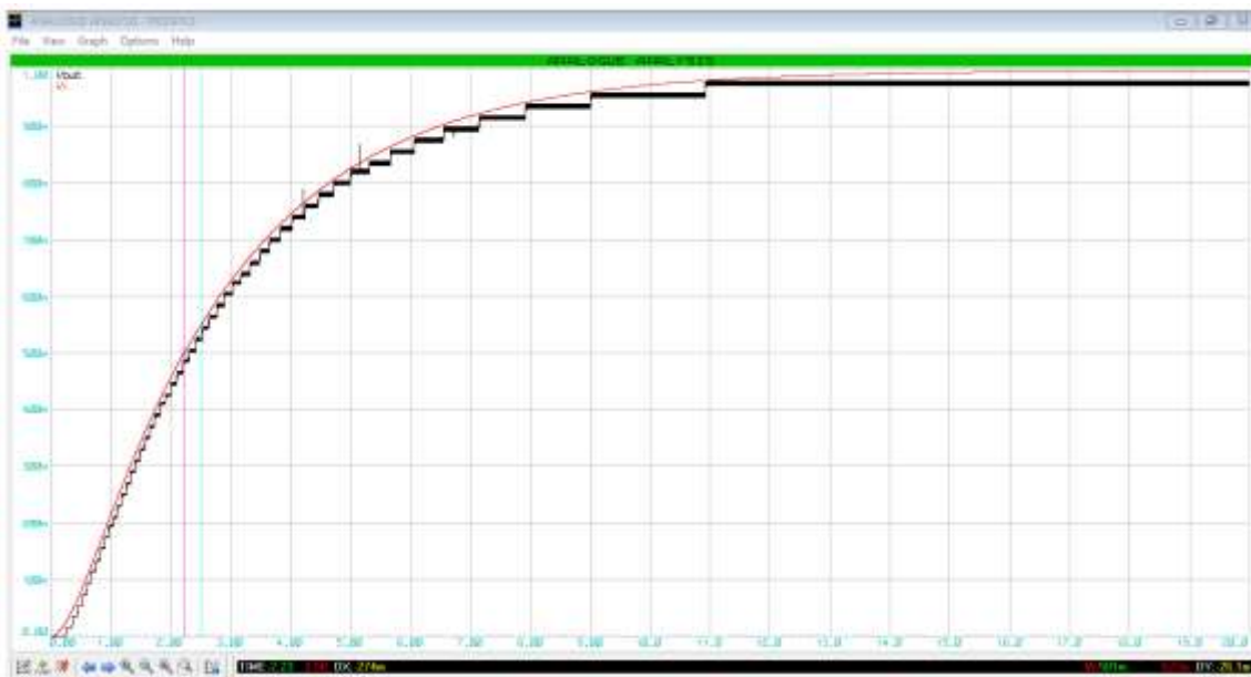
Figura 109 Respuesta en PROSPICE para un factor de convergencia a 0.1 y número de coeficientes a 10
