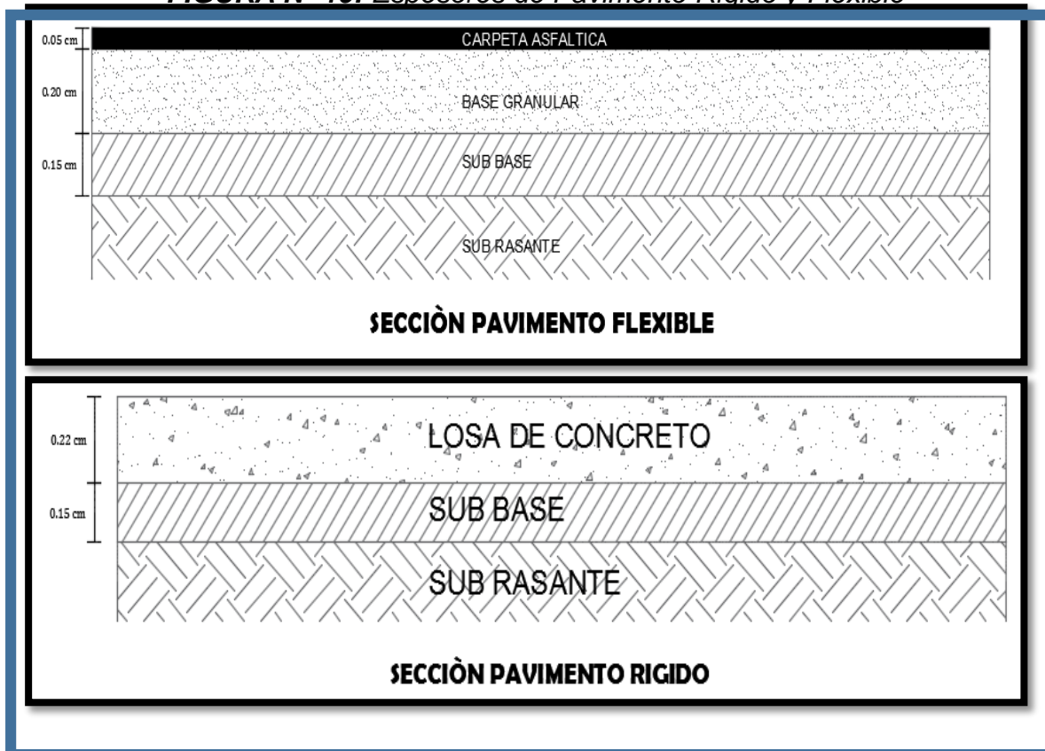
FIGURA N° 19: Espesores de Pavimento Rígido y Flexible
