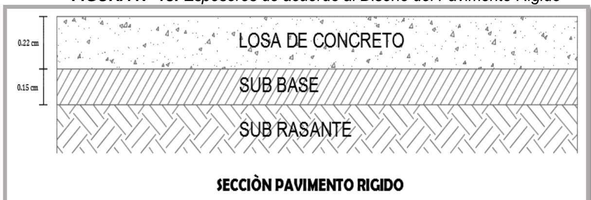
FIGURA Nº 18: Espesores de acuerdo al Diseño del Pavimento Rígido
