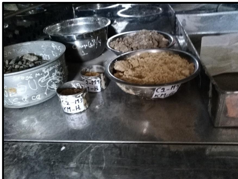
Figura 9.12: Ensayo de Contenido de Humedad (muestra en el horno)
