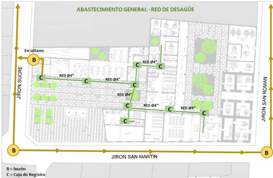
*Ilustración 71: Esquema general de red de abastecimiento de desagüe*
