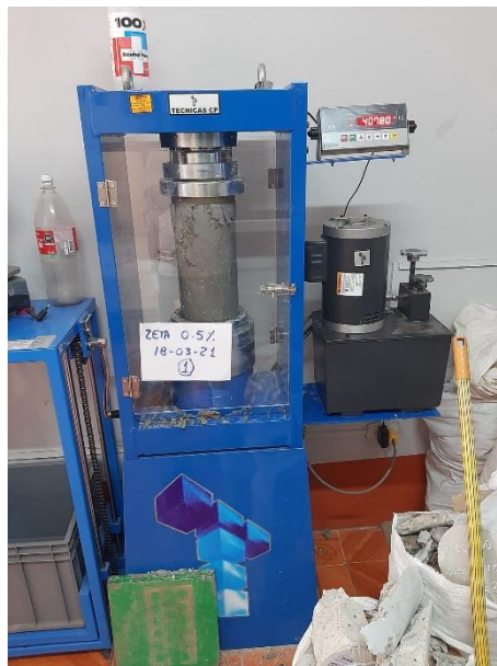
Figura 26: Resistencia a la compresión 3
