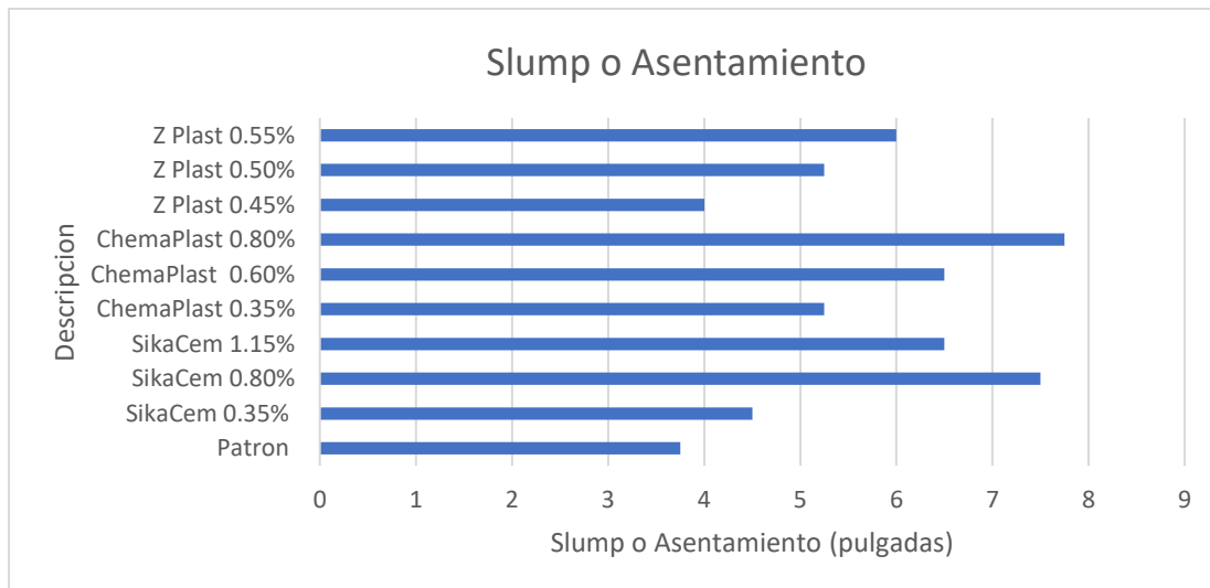
Slump o Asentamiento del concreto en pulgadas
