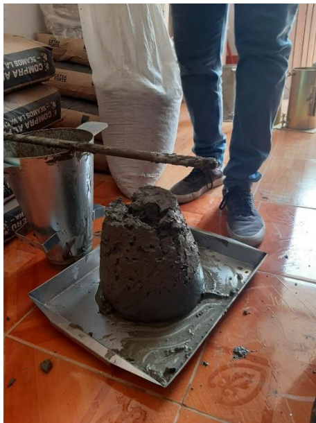
Figura 25: Slump o Asentamiento
