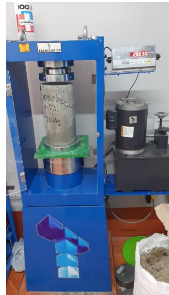
Figura 27: Resistencia a la compresión 2
