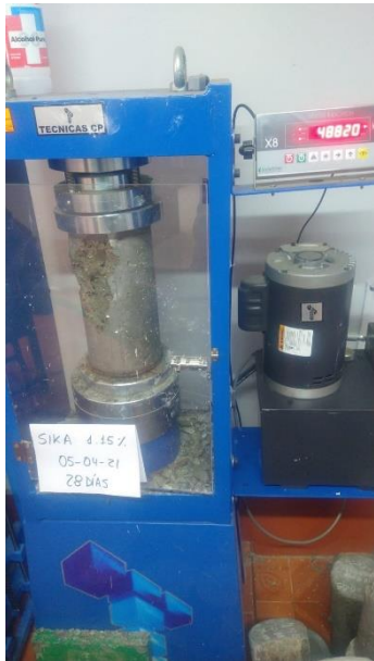
Figura 28: Resistencia a la compresión
