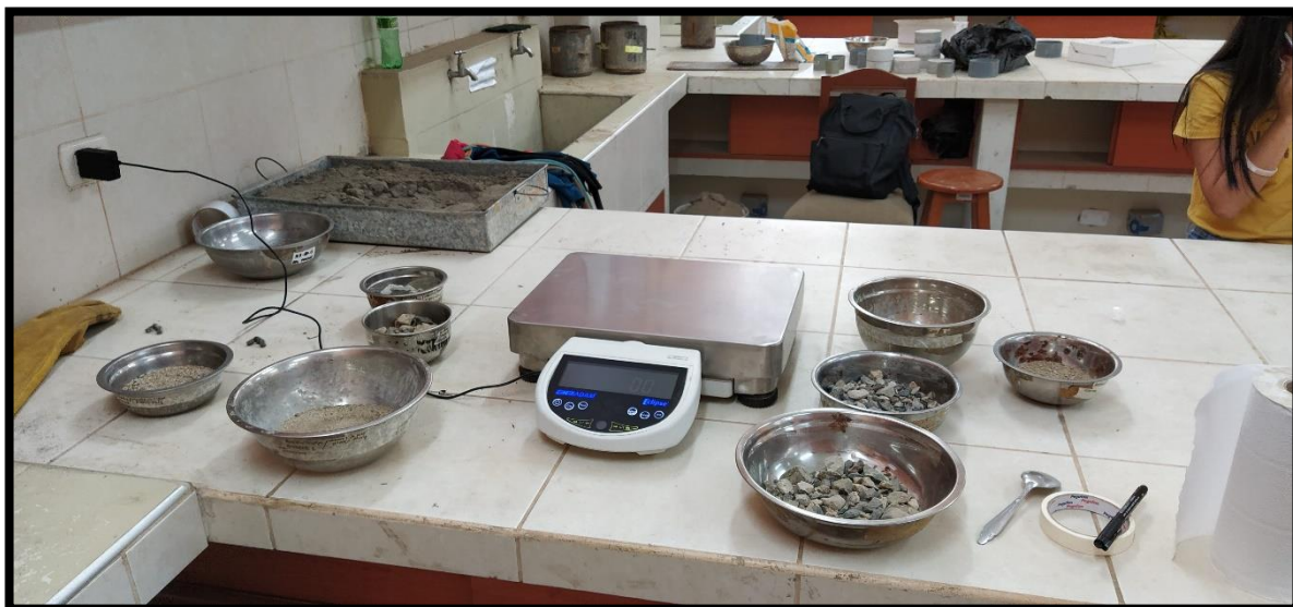
Fotografía N. a 17: Preparando las muestras para ensayo de contenido de humedad en agregados mediante secado.
