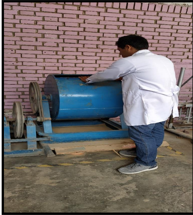
Fotografía N.ª 19: Preparando la maquina de los angeles para ensayo de desgaste abrasivo.
