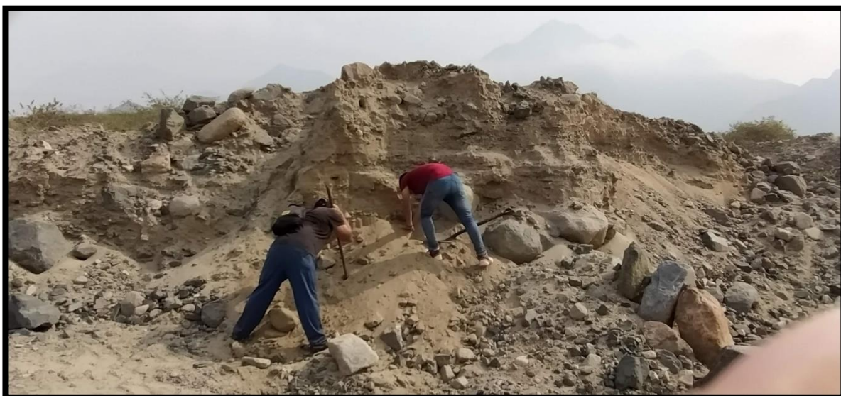
Fotografía N.º 12: Recoleccion de material fino afirmado para laboratorio.
