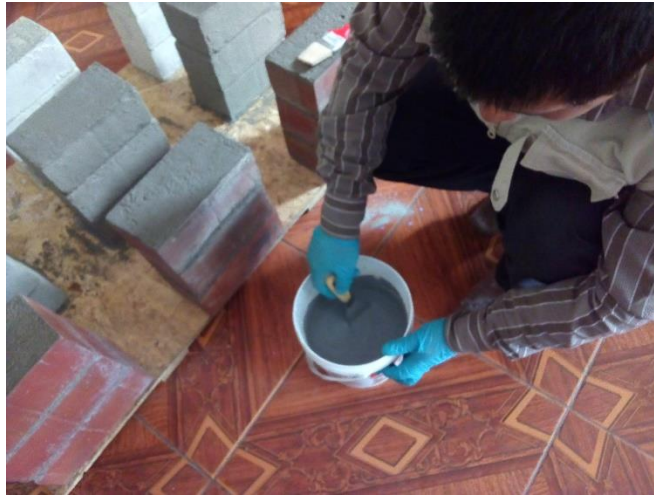
IMAGEN N° 47: Impermeabilizante Chema seal listo para el ensayo.
