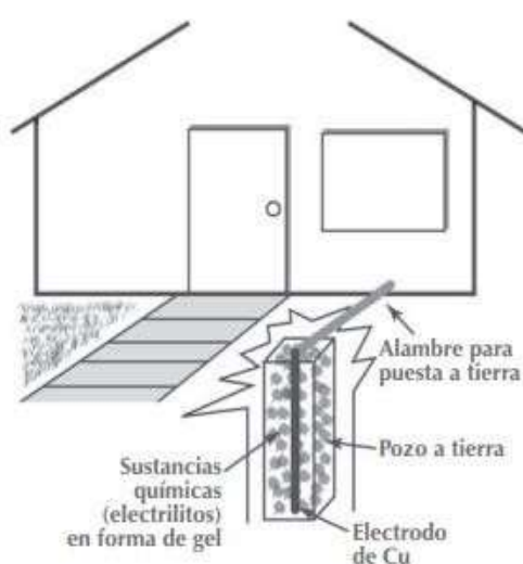
Imagen N° 46 – Pozo a tierra
