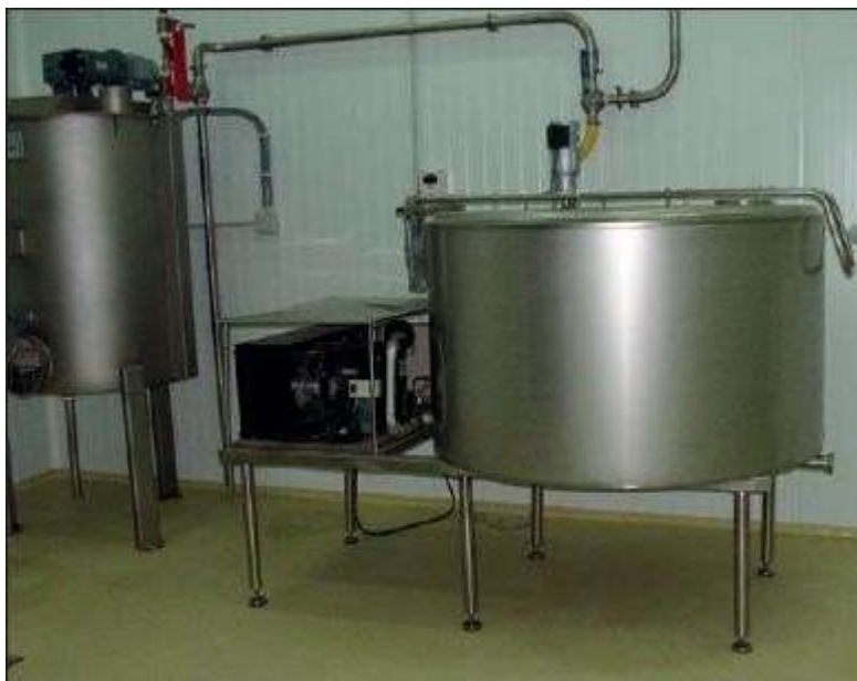
Imagen N° 5 - Depósito de almacenamiento y refrigeración.
