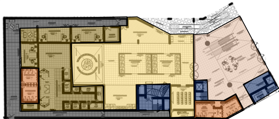
Zonificación del bloque Cultural (Planta Sótano - Museo / Zona de Conservación y Restauración)
