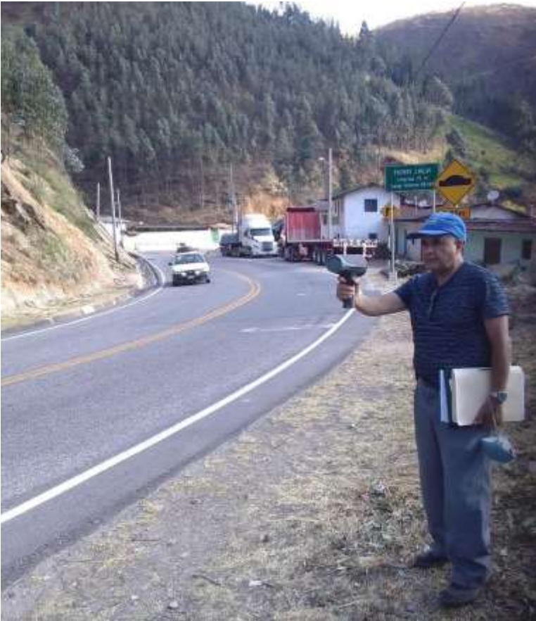
Figura N° 48: Medición de las velocidades de operación
