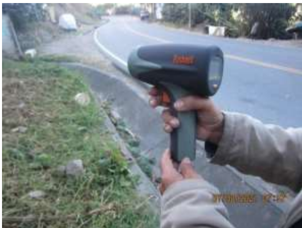
Figura N° 3: Cinemómetro utilizado para la medición de velocidades
