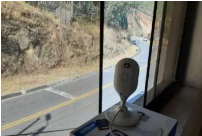
Figura N° 10: Cámara instalada para el conteo de vehículos
