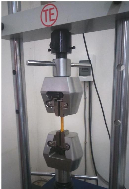
Anexo 1.5. Probeta C 70 x 60 sometida a ensayo de tracción
