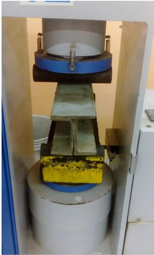
Anexo 1.12 Ensayo de flexión sección Doble C 100 x 100
