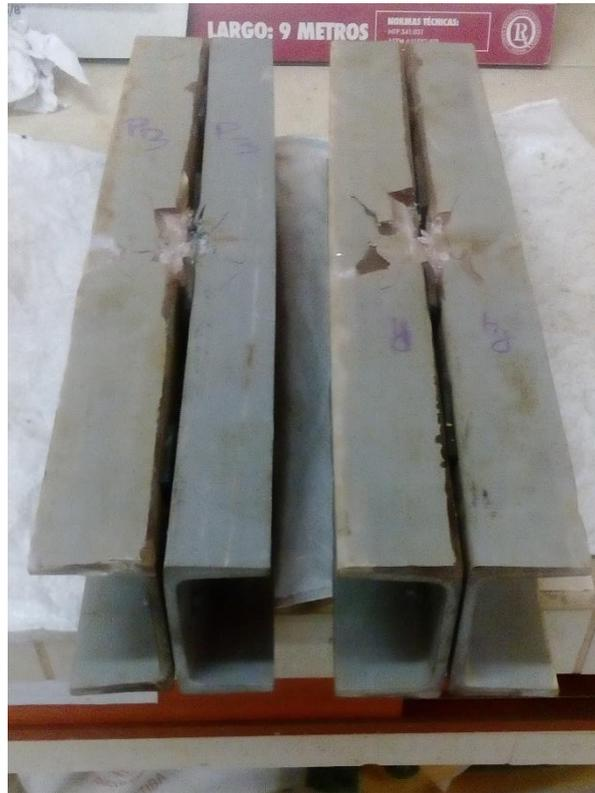
Anexo 1.16. Probeta colapsada perfil Doble C 100 x 40
