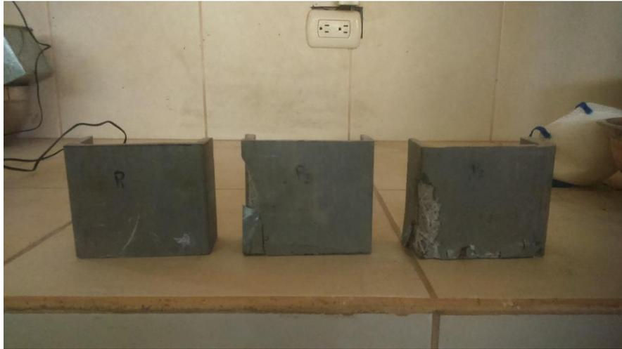
Anexo 1.8. Probetas C 100 x 40 colapsadas en ensayo de compresión
