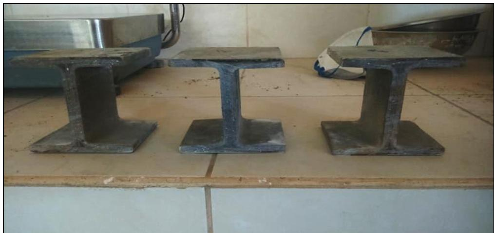
Figura 7: Probetas cortas H 100 x 100
