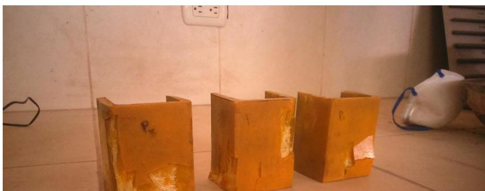
Anexo 1.10. Probetas C 700 x 60 colapsadas en ensayo a compresión
