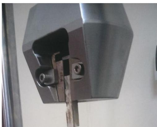
Anexo 1.6. Probeta C 100 x 40 colapsada en ensayo a tracción
