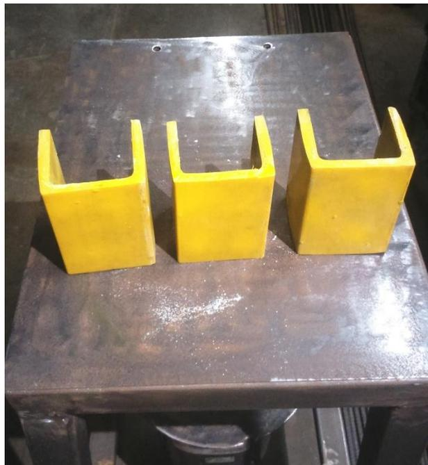
Anexo 1.3. Probetas cortas C 70 x 60 para ensayos de compresión
