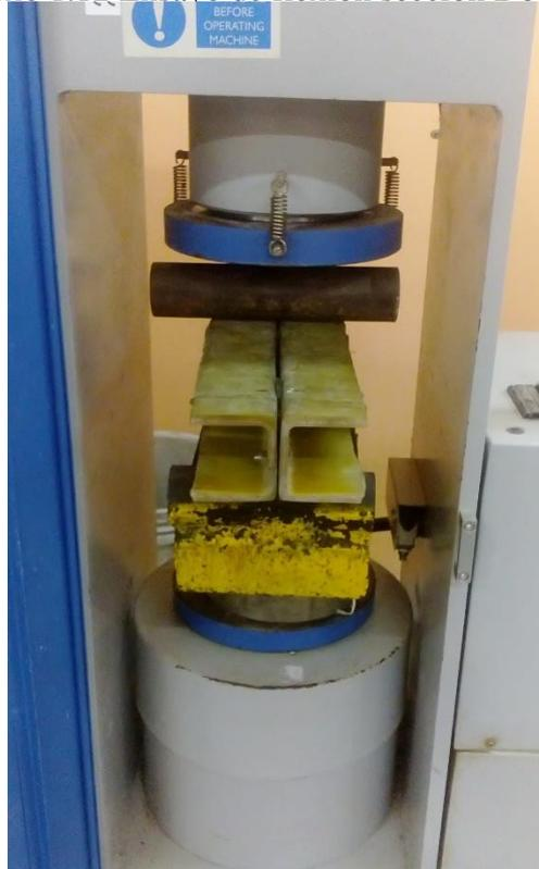
Anexo 1.13 Ensayo de flexión sección Doble C 70 x 60
