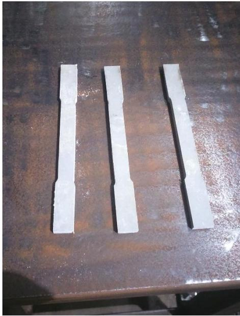
Anexo 1.2. Probetas a tracción maquinadas
