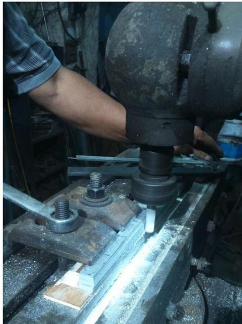
Anexo 1.1. Maquinado de probeta a Tracción
