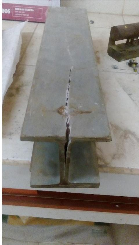
Anexo 1.14 Probeta colapsada perfil H 100 x 100
