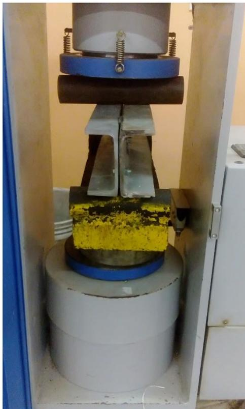
Anexo 1.11 Ensayo de flexión sección Doble C 70 x 40
