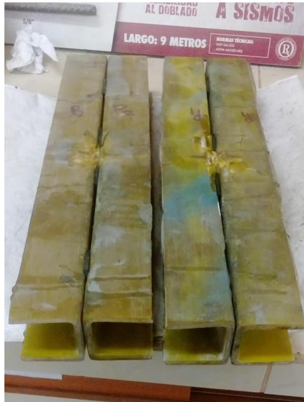
Anexo 1.15. Probeta colapsada perfil Doble C 70 x 60
