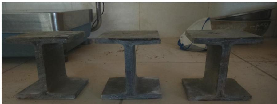
Anexo 1.4. Probetas cortas H 100 x 100 para ensayos de compresión
