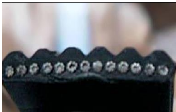
Figura 2.2. Cables de suspensión
