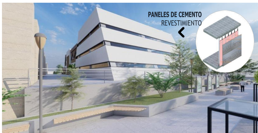
IMAGEN N° 122: Materialidad de las fachadas.
