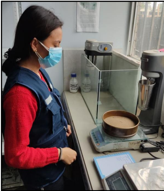
Obtención de datos, a base de los pesos del material restante en cada tamiz.
