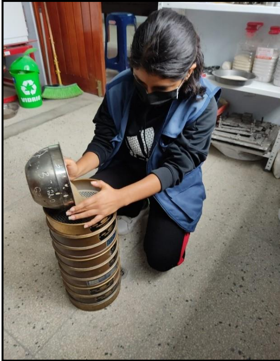
Colocación de la muestras y proceso de tamizado.
