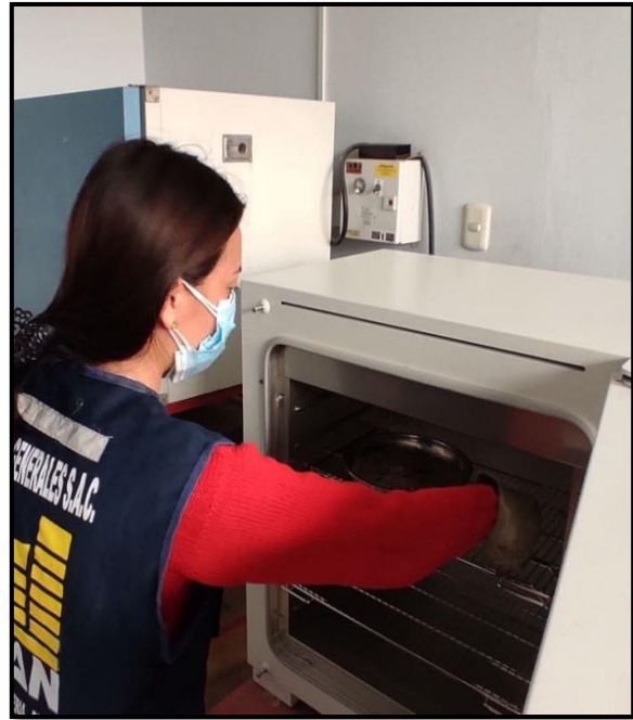
Peso de muestras y colocación al horno.
