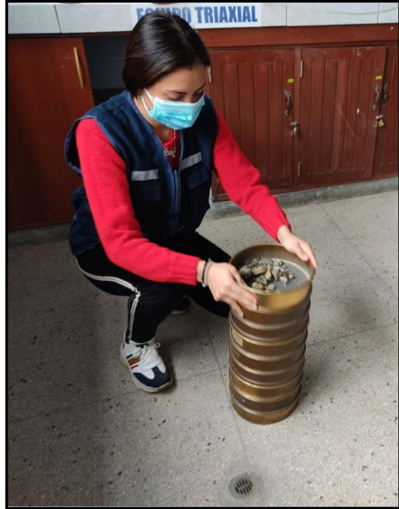
Colocación de la muestras y proceso de tamizado.
