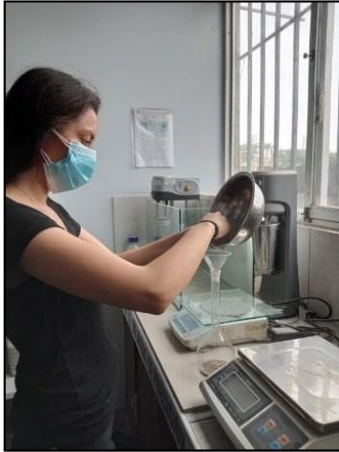
Introducción de la muestra dentro del picnómetro.
