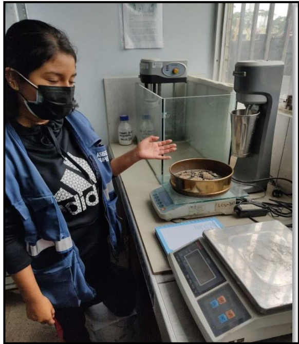
Obtención de datos, a base de los pesos del material restante en cada tamiz.
