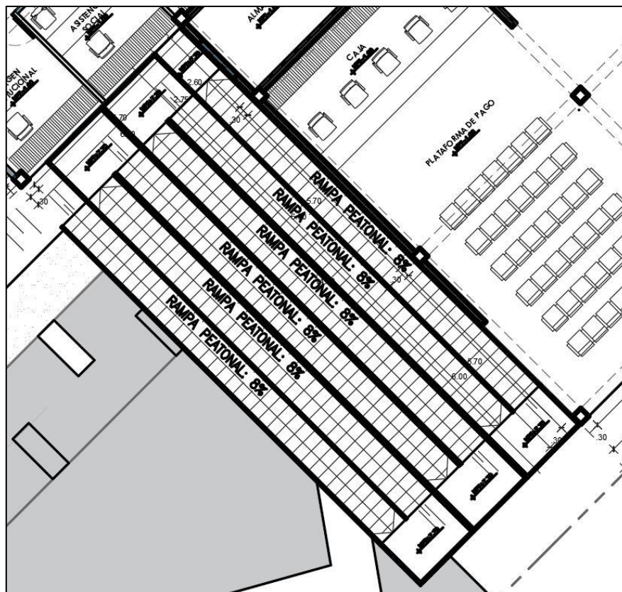
Figura 59. Planta de rampa Fuente: Elaboración Propia
