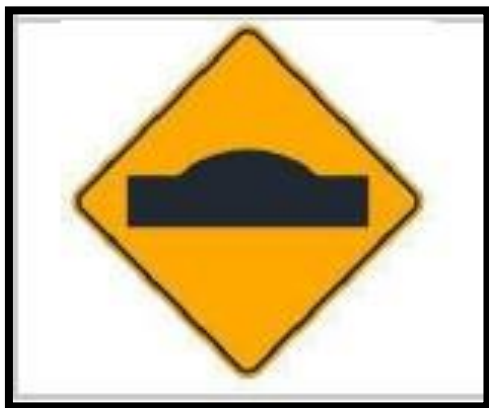
Señal Proximidad Reductor de Velocidad Tipo Resalto (P-33A)
