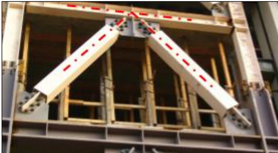
Figura 11 : Pórtico con arriostres SCBF
