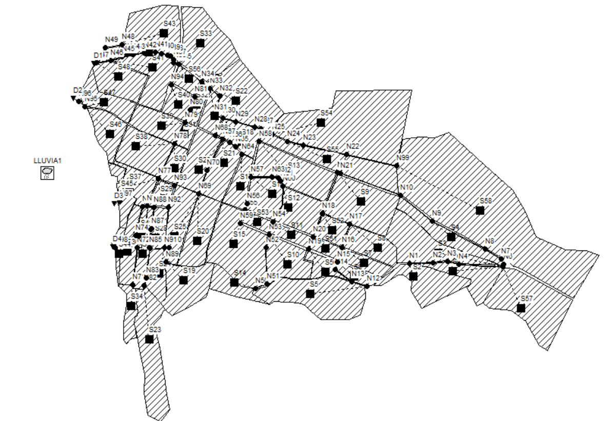
Figura 11: Componentes del modelamiento de drenaje pluvial urbano
