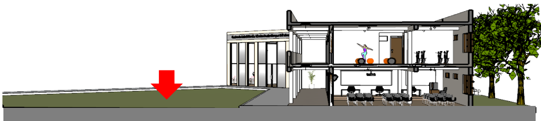
Figura N° 28: Creación de plazas deprimidas en el terreno
