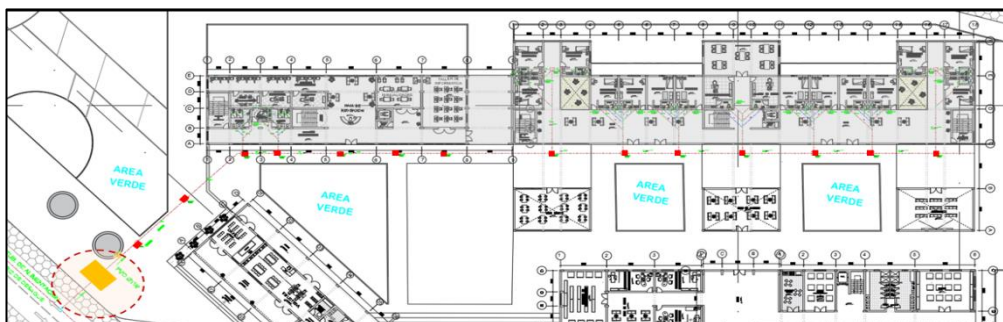
Figura N° 124: Planteamiento sistema de desagüe
