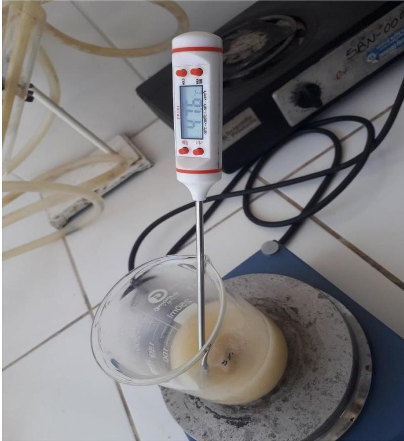
**Medición de temperatura de la mezcla**
