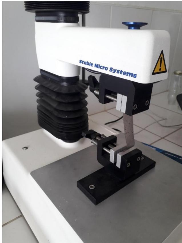
**Pruebas mecánicas en el texturómetro**
