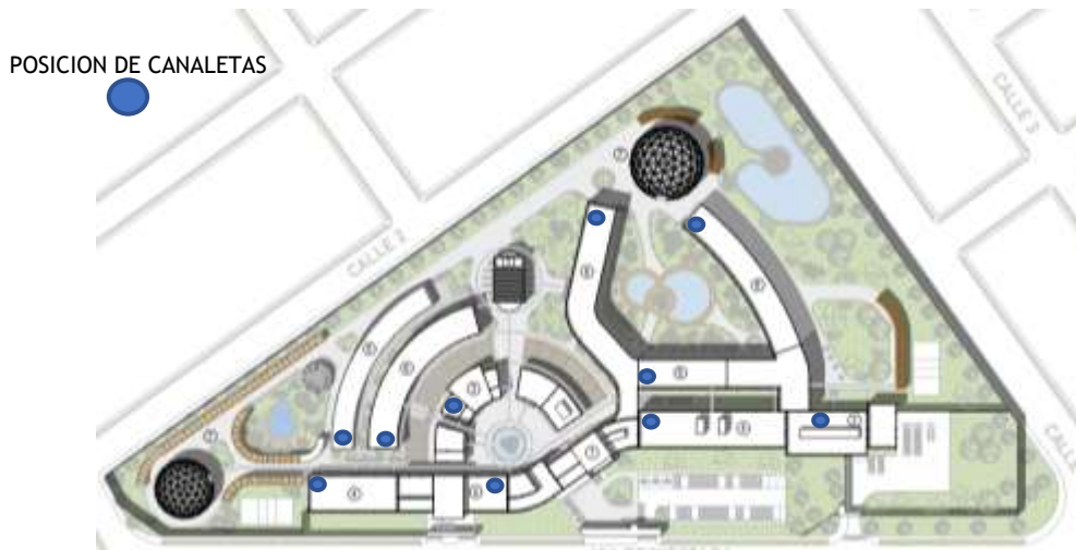
Figura 200. Plano de techos drenaje pluvial.
