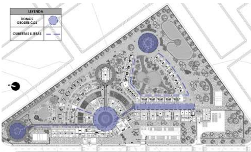
Figura 183. Planteamiento de cubiertas geodésicas. Fuente: Elaboración Propia
