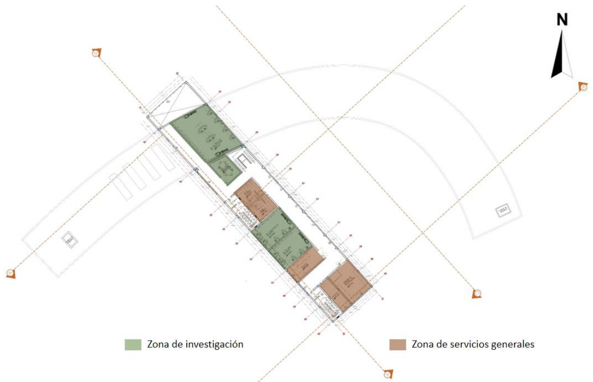
figura n°33: Zonificación tercer nivel
