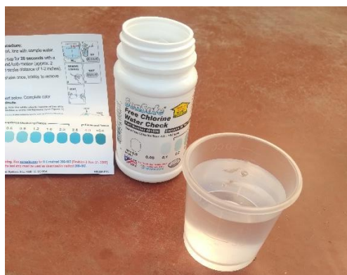
Imagen 12: Procedimiento de medición de cloro en el agua.
